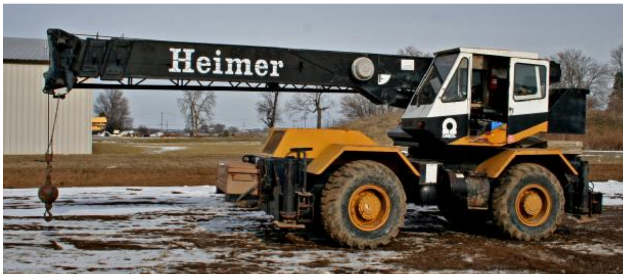
Εικόνα 1.3 : Γερανός για ανώμαλο έδαφος
