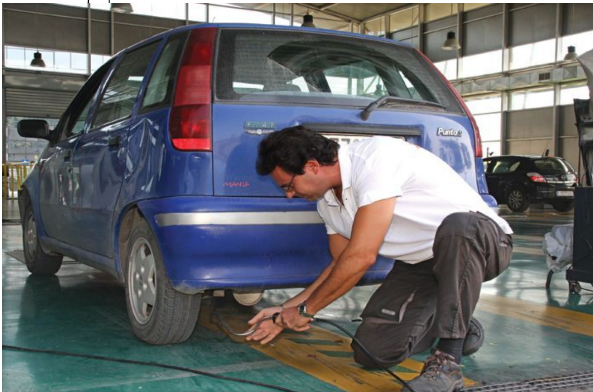
Εικ. Λήψης καυσαερίων από βενζινοκίνητο όχημα.
