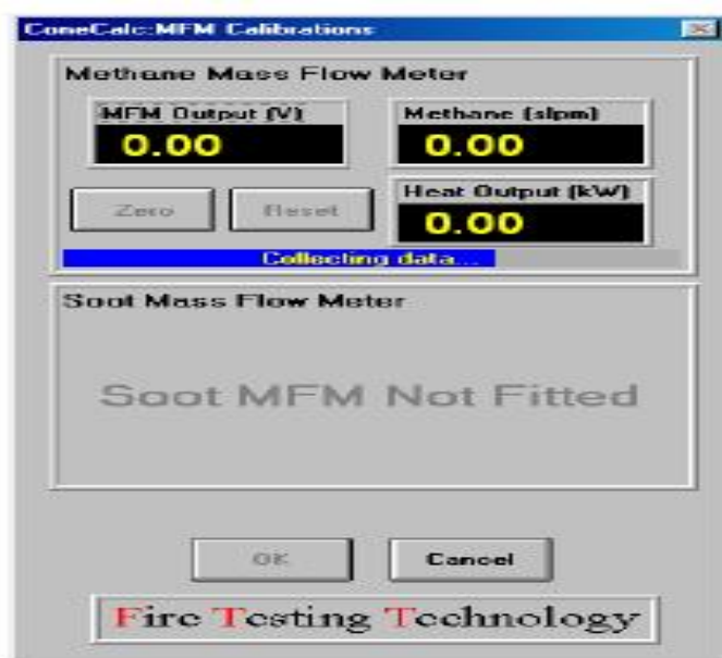
Εικόνα 75: Βαθμονόμηση Παροχόμετρου Μεθανίου (MFM Calibration Panel)
