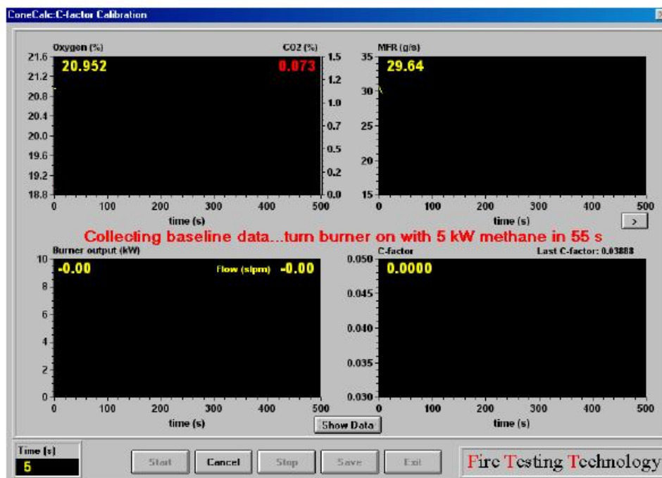
Εικόνα 88: Διαδικασία Εύρεσης του Συνολικού συντελεστή βαθμονόμησης C-Factor – Βήμα1.
