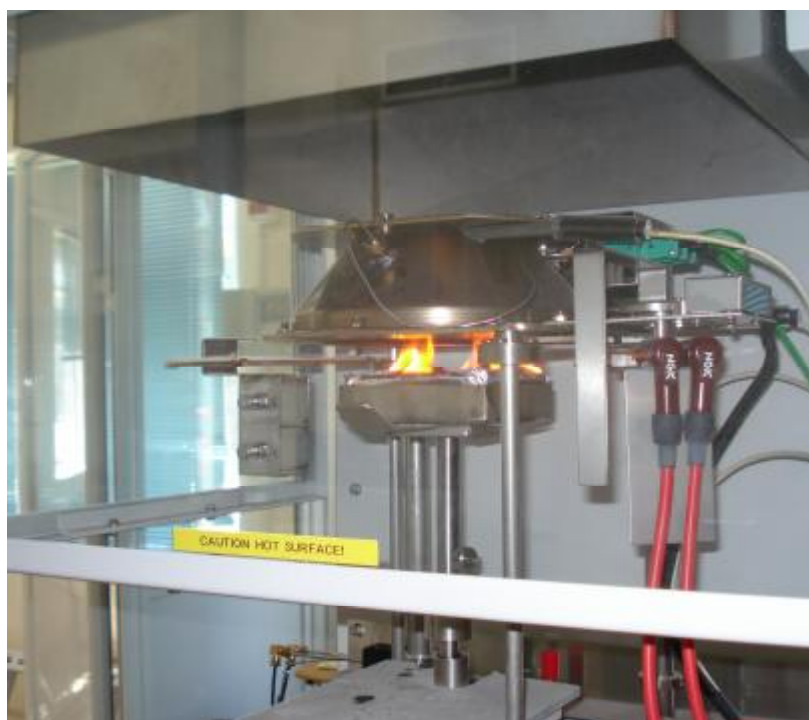
Εικόνα 36: Τυπική εικόνα καύσης δοκιμίου κατά την διαδικασία ελέγχου δοκιμίου ως προς την αντίδρασή του στη φωτιά.
