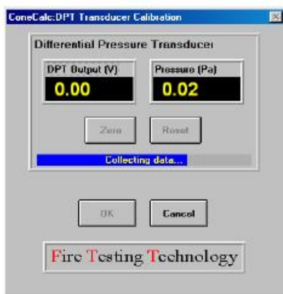
Εικόνα 76: Βαθμονόμηση Μανομέτρου μέτρησης πίεσης (DPT Transducer Calibration Panel).
