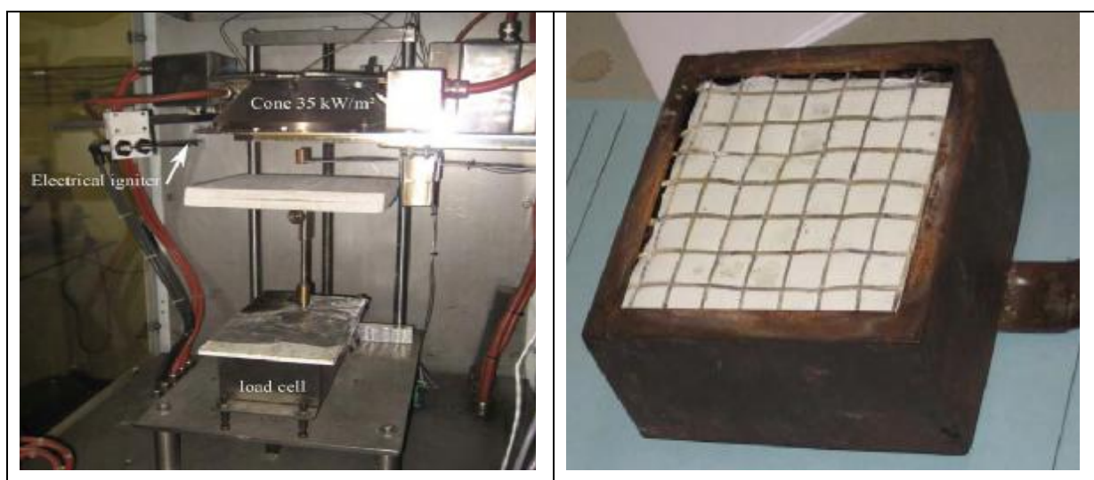
Εικόνα 37: Διάταξη κώνου καλορίμετρου και μεταλλικό πλέγμα εφαρμογής στην επιφάνεια δοκιμίου.
