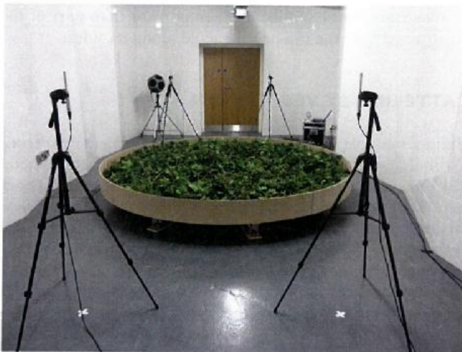
Εικόνα 4.5 : Ένα στρεφόμενο τραπέζι για τη μέτρηση του συντελεστή διασκόρπισης μιας δέσμης φύλλων.
