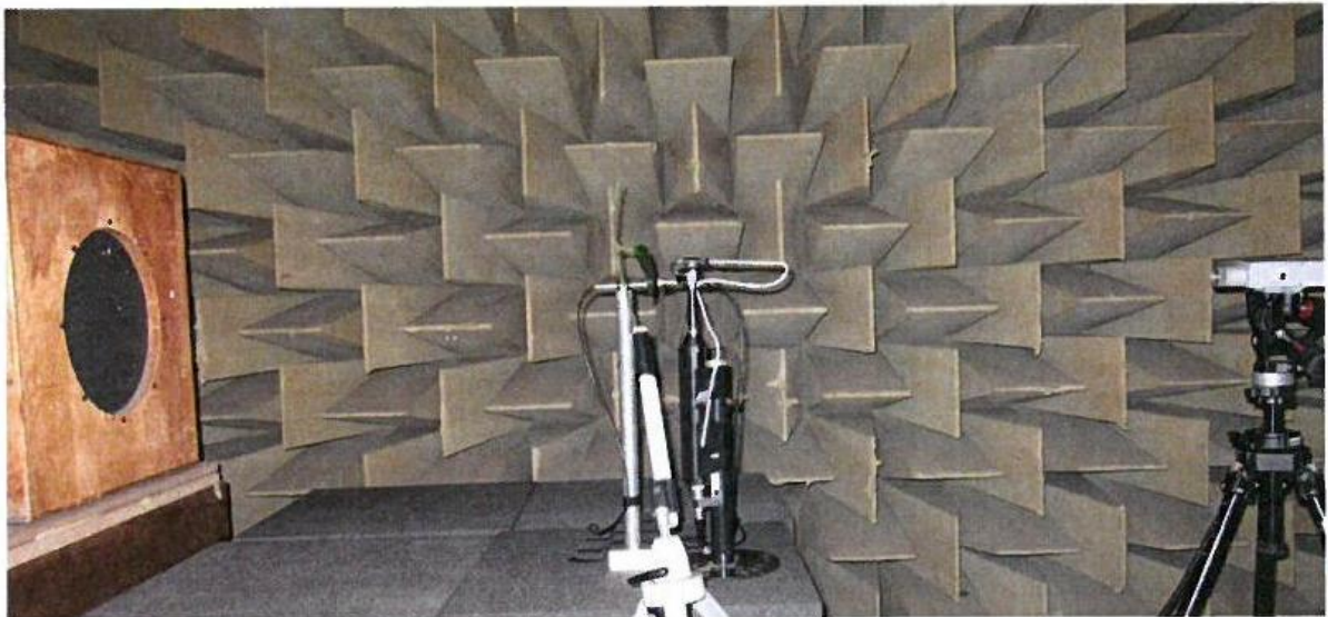
Εικόνα 4.3 : Πειραματική διάταξη για τη μέτρηση των δονήσεων για ένα φύλλο στο ηχητικό πεδίο με ένα laser μετρητή δονήσεων Doppler, σε συνδυασμό με τη μέτρηση πτώσης ακουστικής πίεσης πάνω από το φύλλο.
