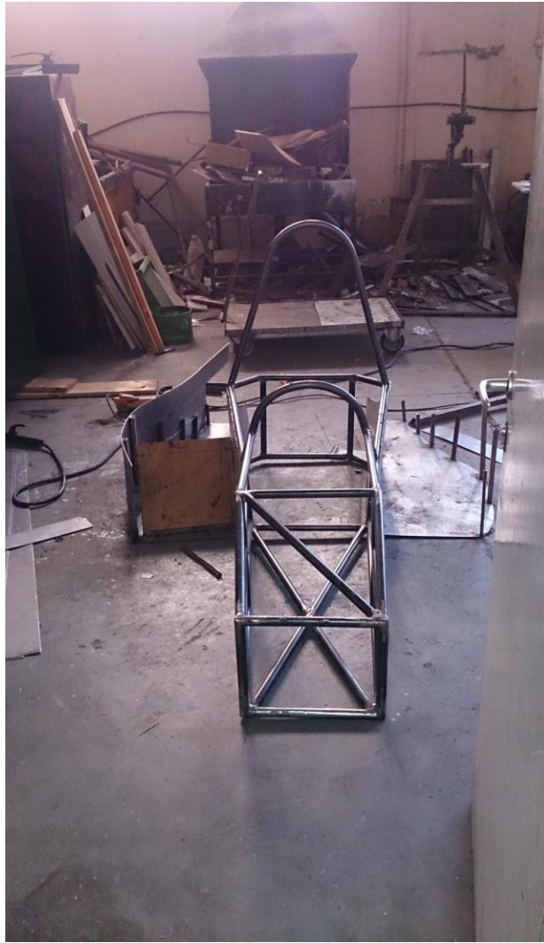
Εικόνα: 8.44 Το πλαίσιο μαζί με τα δύο καλούπια των αεραγωγών σε πρώιμο στάδιο.
