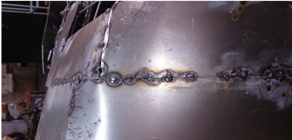
Εικόνα: 8.28 Συγκολληση φύλλων λαμαρίνας κύριου καλοπιού
