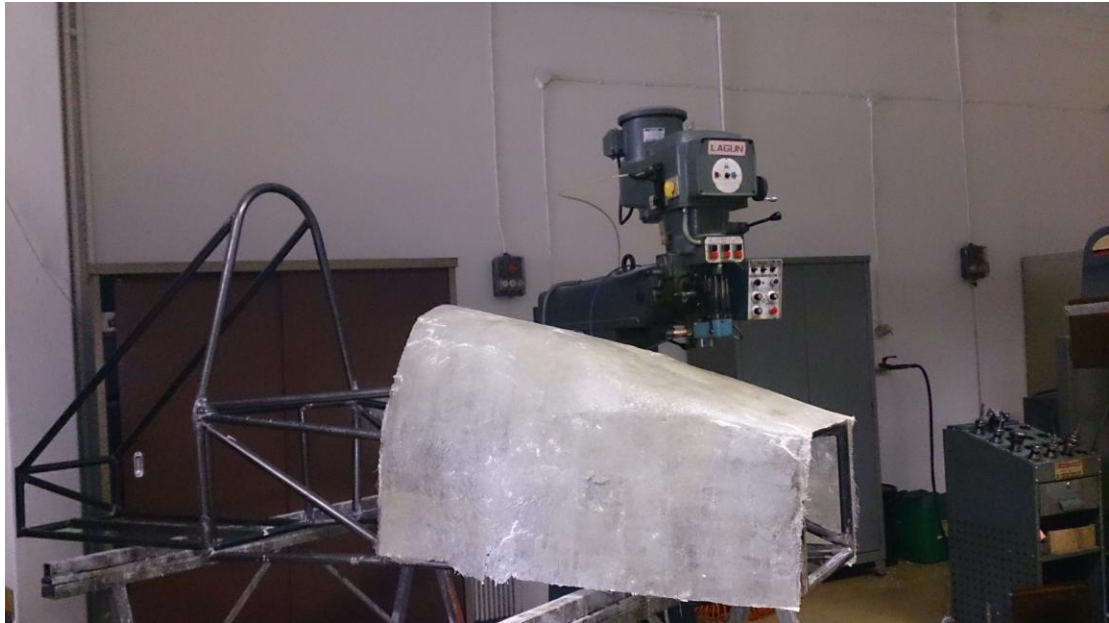
Εικόνα: 8.56 Δοκιμή εφαρμογής πολυεστερικού καλοπιού πάνω στο πλαίσιο
