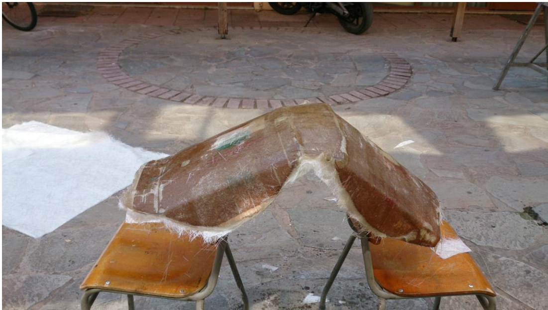
Εικόνα: 8.64 Κατά την φάση σκλήρυνσης του πολυεστέρα
