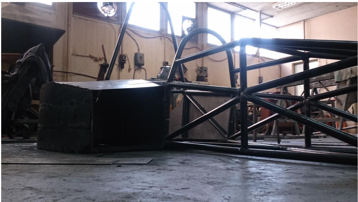
Εικόνα: 8.46 Πλαίσιο μαζί με καλούπι αεραγωγού
