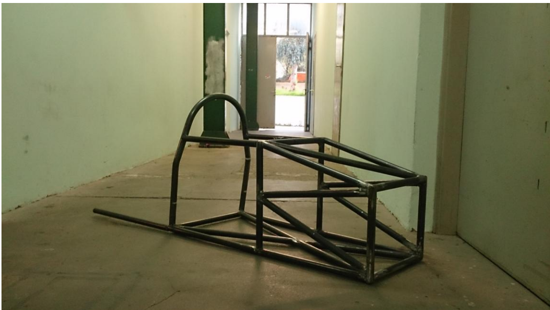
Εικόνα: 8.19 Πλαίσιο μέχρι και το Front Roll Hoop
