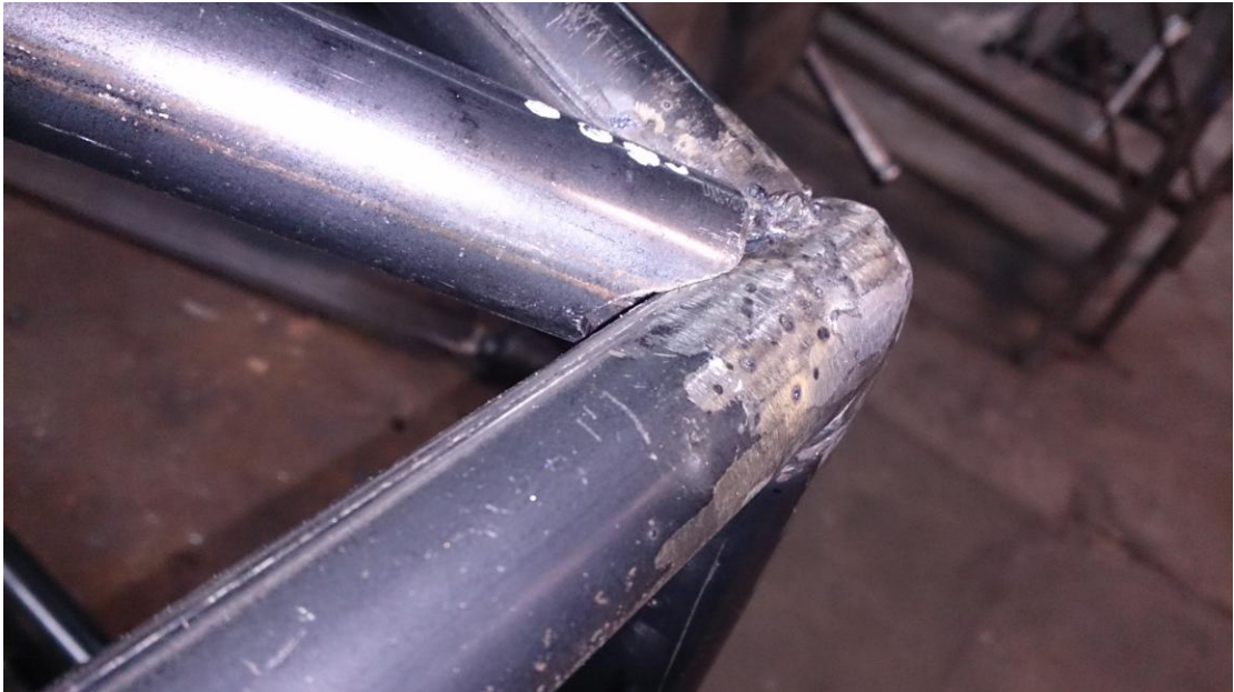
Εικόνα: 8.7 Ταίριασμα σωλήνων Front Bulkhead με το υπόλοιπο πλαίσιο
