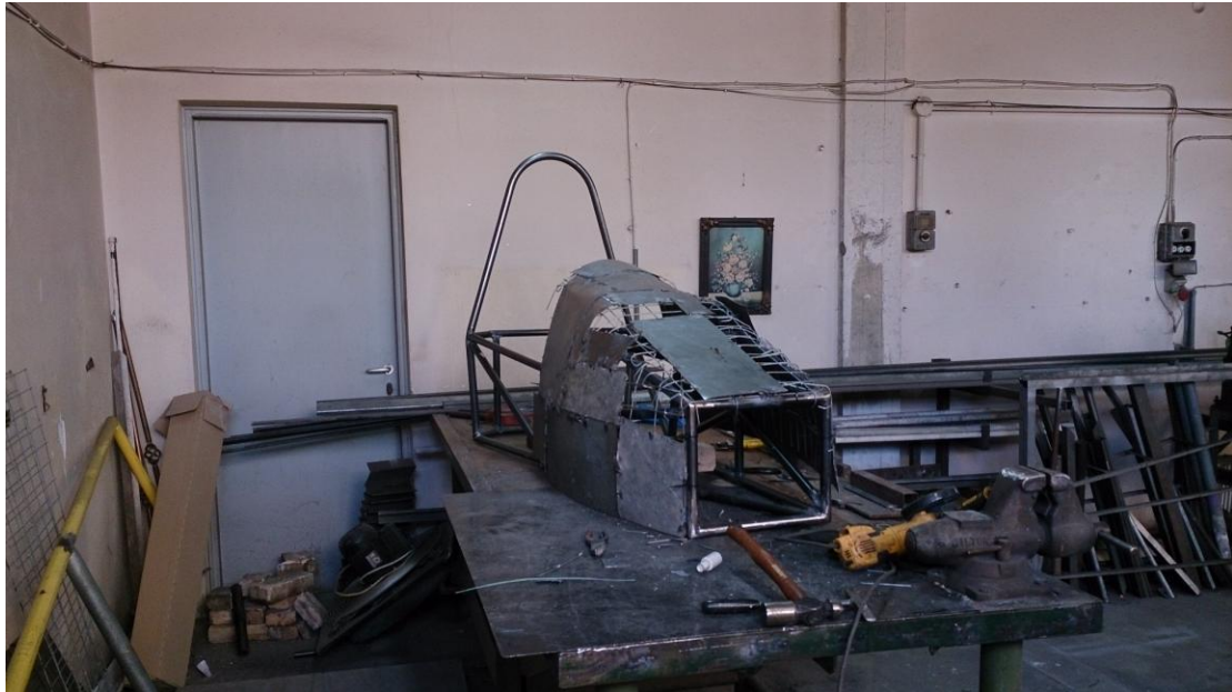
Εικόνα: 8.25 Τυχαία άποψη κατά την κατασκευή του κύριου καλουπιού από λαμαρίνα
