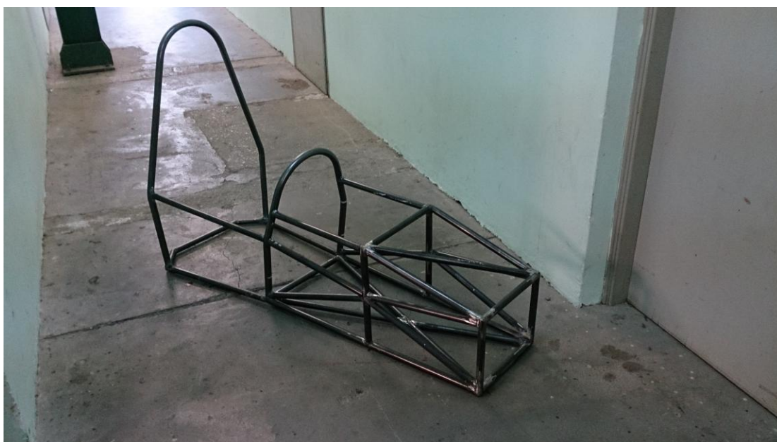
Εικόνα: 8.21 Ημιτελές πλαίσιο μέχρι και το Main Roll Hoop
