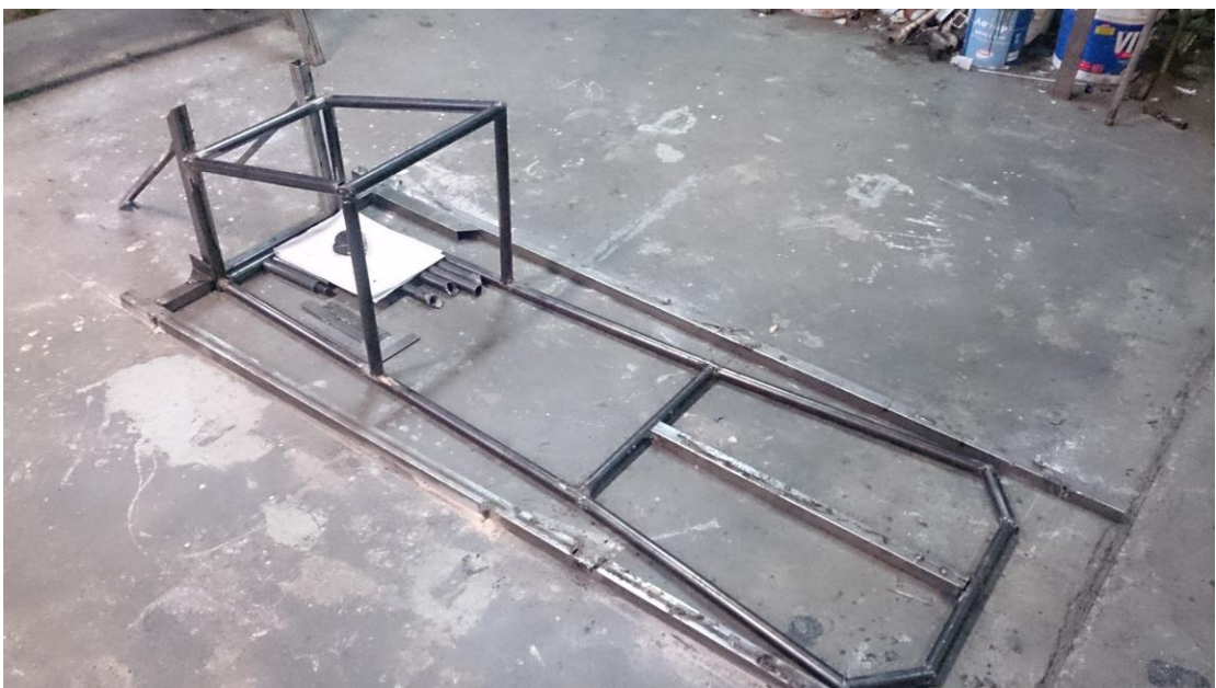
Εικόνα: 8.17 Κάτω μέρος πλαισίου, διαμορφωμένο μέχρι και την θέση οδήγησης
