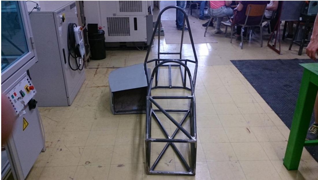
Εικόνα: 8.51 Έτοιμο καλούπι αεραγωγού μαζί με πλαίσιο
