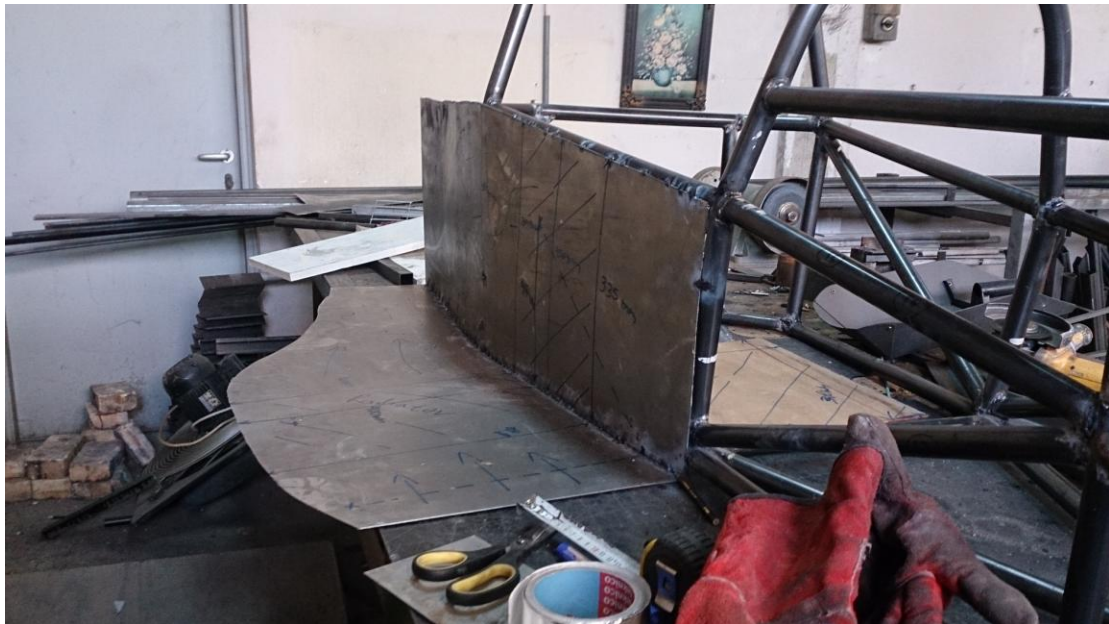
Εικόνα: 8.40 Κατασκευή καλουπιού δεξιού αεραγωγού από λαμαρίνα
