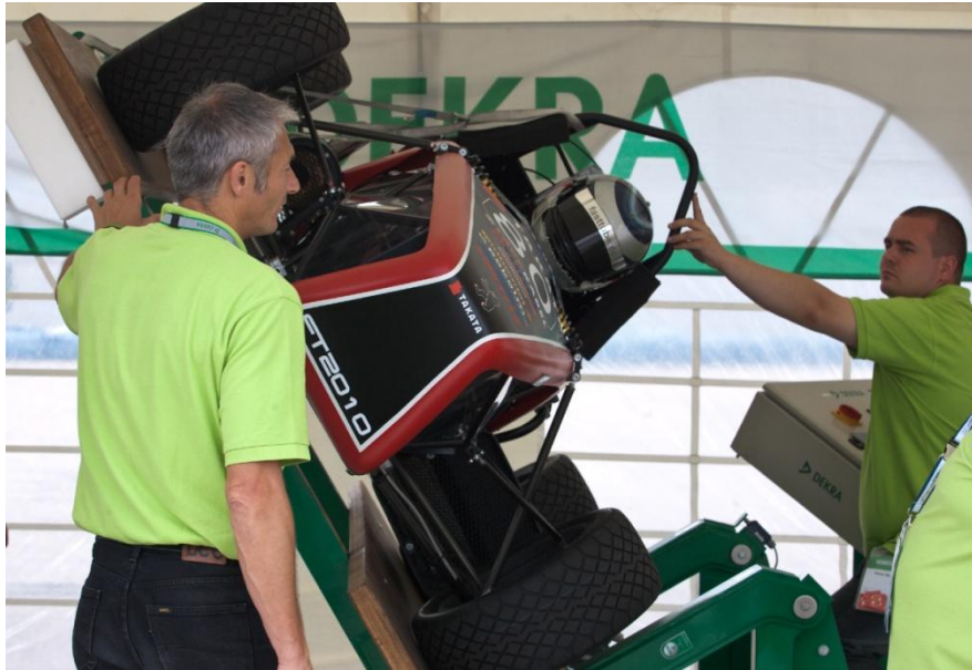
Εικόνα: 5.3 Roll over inspection
