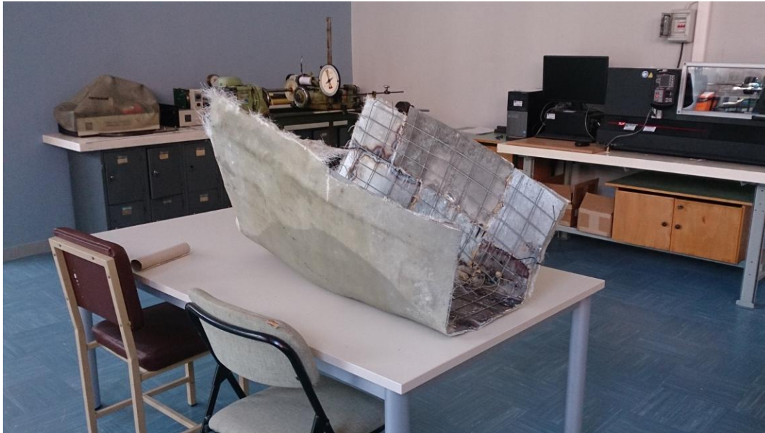
Εικόνα: 8.54 Φάση κατά την αποκόλληση του πολυεστερικού κύριου μέρους
