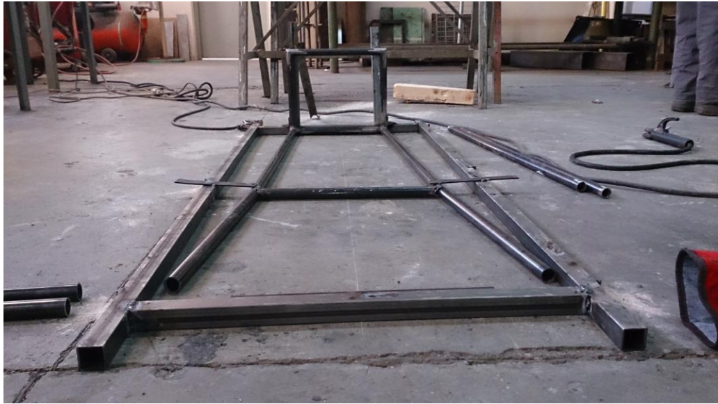
Εικόνα: 8.12 Υποπλαίσιο ευθυγράμμισης κύριου πλαισίου
