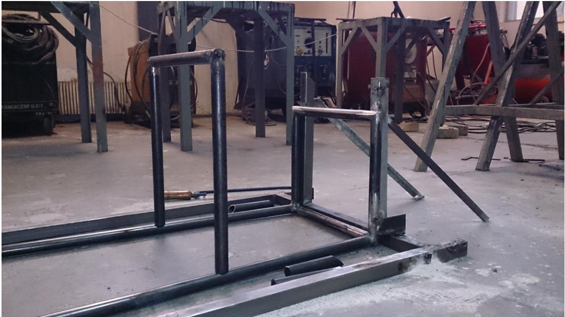
Εικόνα: 8.16 Front Bulkhead μαζί με τα πρώτα κομμάτια του υπόλοιπου πλαισίου
