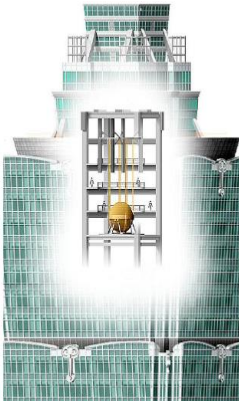
Σχήμα 3.11 Παράδειγμα χρήσης συντονισμένου αποσβεστήρα μάζας - Tuned Mass Damper ( http://pioneer.netserv.chula.ac.th/~anopdana/433/ch62.pdf ).
