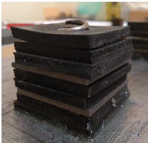
Σχήμα 8.19 Μορφολογία ελαστομεταλλικών ελατηρίων με ελατήριο.
