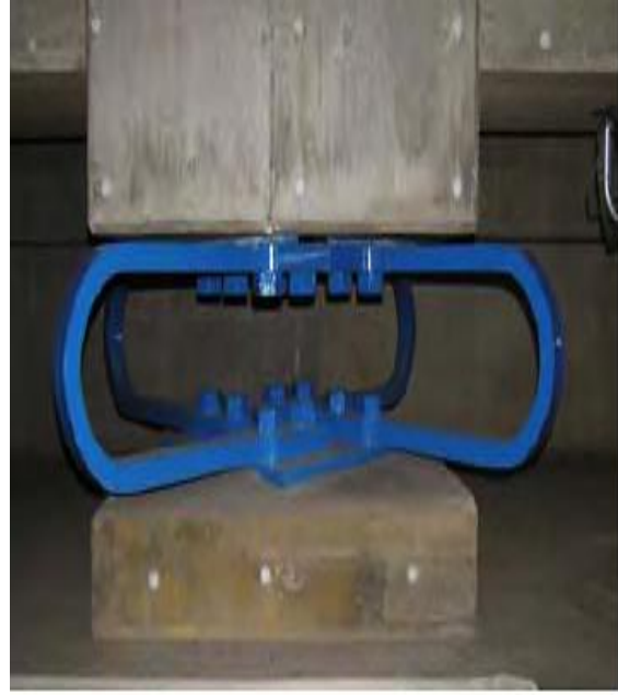
Σχήμα 3.7 Μεταλλικοί αποσβεστήρες τριγωνικής μορφής (αριστερά) και μορφής - U (δεξιά) ( ijetae.com & Jiao/Kishiki, 10 NCEE, 2014 ).
