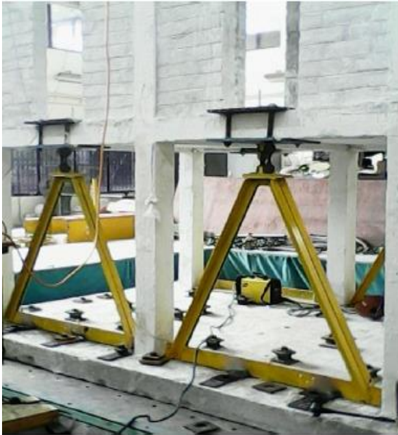
Σχήμα 3.7 Μεταλλικοί αποσβεστήρες τριγωνικής μορφής (αριστερά) και μορφής - U (δεξιά) ( ijetae.com & Jiao/Kishiki, 10 NCEE, 2014 ).
