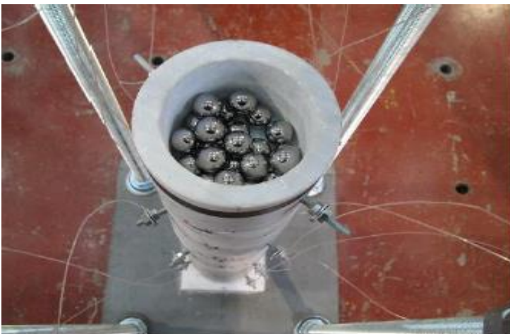
Σχήμα 3.9 Σωματίδια αποσβεστήρες εντός σφονδύλου κίνου (A. Papalou, 2014 & A. Papalou, 2015).
