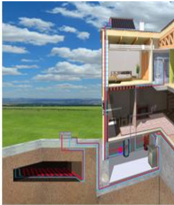
(β) Οριζόντια Κλειστού κυκλώματος
