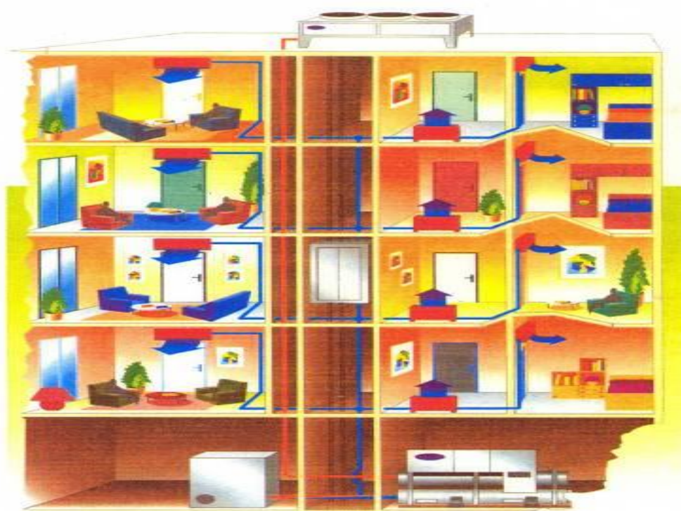
ΣΥΣΤΗΜΑ ΚΛΙΜΑΤΙΣΜΟΥ ΜΕ ΝΕΡΟ ΚΑΙ FCU
