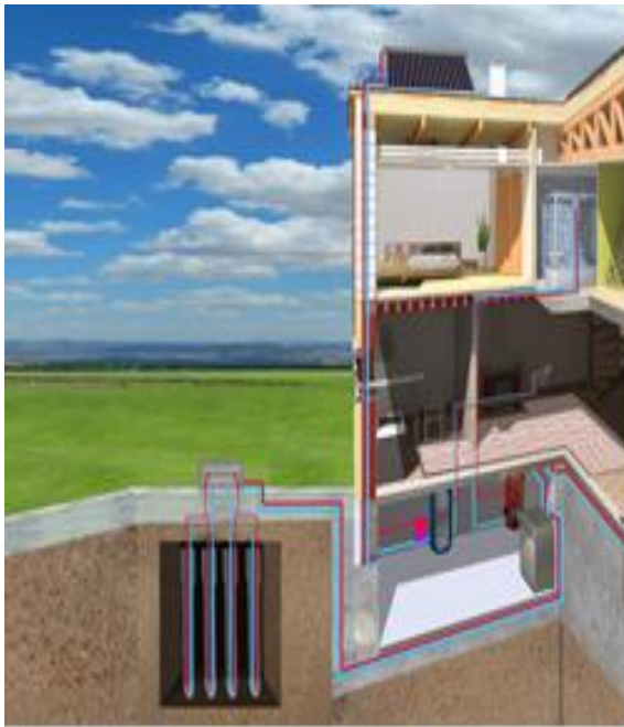
(α) Κάθετη Κλειστού κυκλώματος
