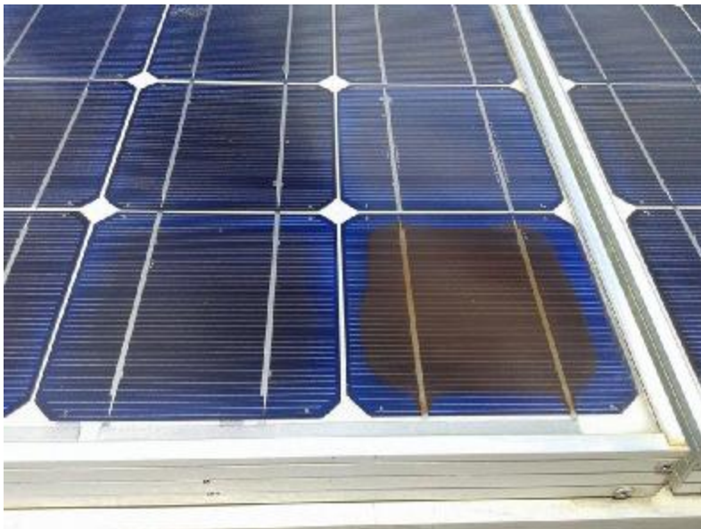
5.5.1 Εικόνα. Ενεργειακή υποβάθμιση λόγω EVA.
