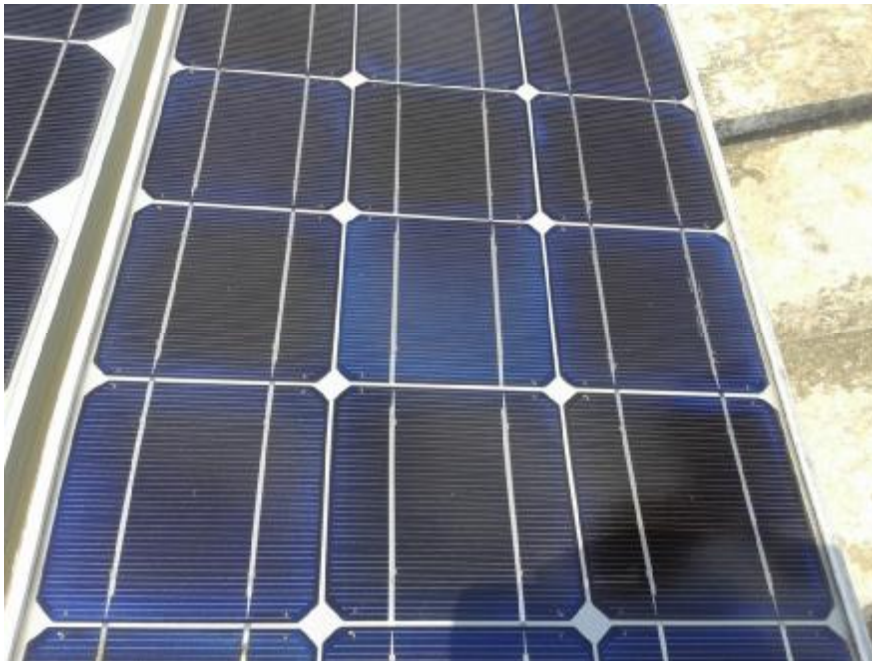
5.5.2 Εικόνα .Ενεργειακή υποβάθμιση επικάλυψης AR λόγω πιθανής σκίασης των πλαισίων
