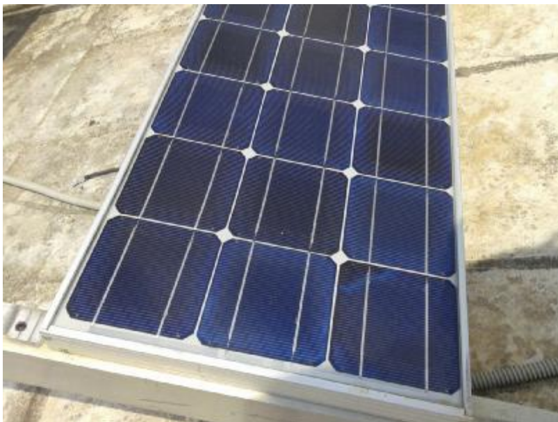
5.5.2 Εικόνα .Ενεργειακή υποβάθμιση επικάλυψης AR λόγω πιθανής σκίασης των πλαισίων
