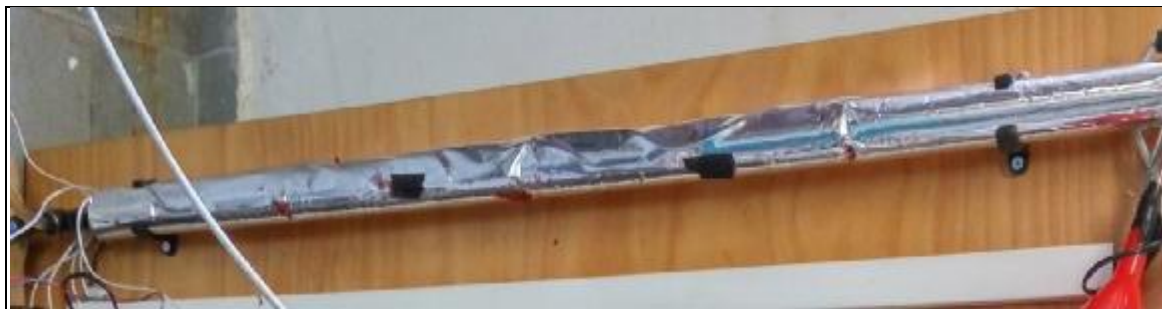
Σχήμα 3.3: Σωλήνας μήκους 1m τυλιγμένος με μονωτικό υλικό.
