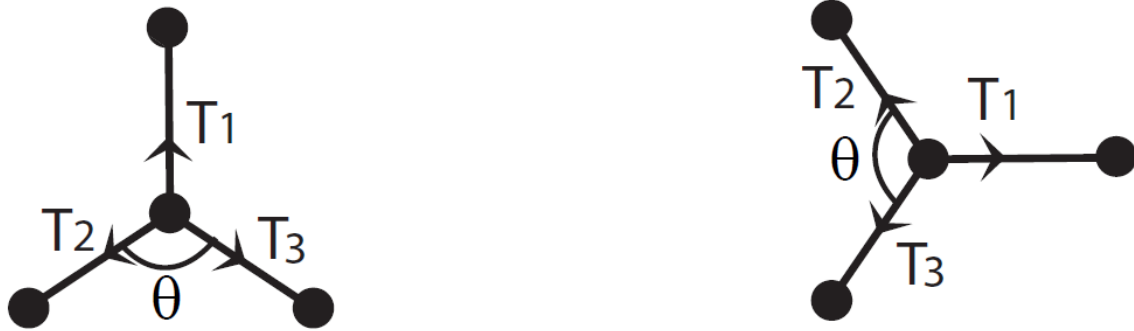
Σχήμα 4.13: Απεικόνιση δυνάμεων που μεταφέρονται από τους δεσμούς. (αριστερά) για φύλλα γραφενίου armchair και (δεξιά) για φύλλα γραφενίου zigzag .
