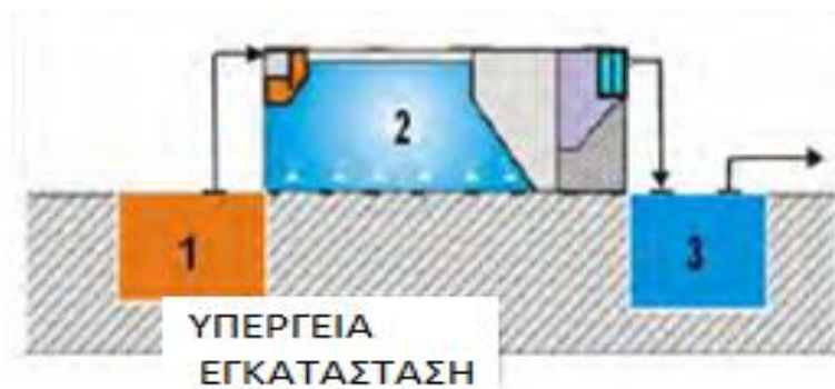
Εικόνα 1.6: Απεικόνιση υπόγειας εγκατάστασης βιολογικού καθαρισμού
