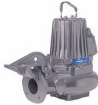
Εικόνα 2.12: Υποβρύχια αντλία της εταιρίας Flygt Hellas τύπου CP 3152 MT παροχής 261 m 3 /h και ισχύος 13,5 kW.
