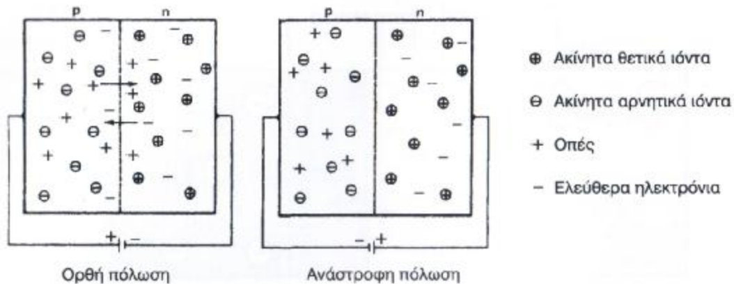
Εικόνα 4: Ηλεκτρική τάση στα άκρα διόδου επαφής
