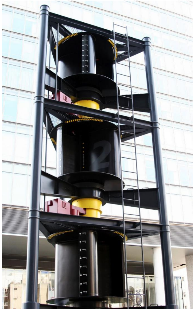
Σχήμα 1.9 Σύστημα με πολλαπλές ανεμογεννήτριες τύπου Savonius [5].
