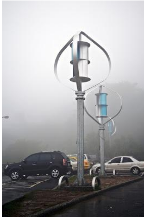
Σχήμα 1.10 Συνδυασμός των τύπων Darrieus και Savonius σε μια ανεμογεννήτρια [5].
