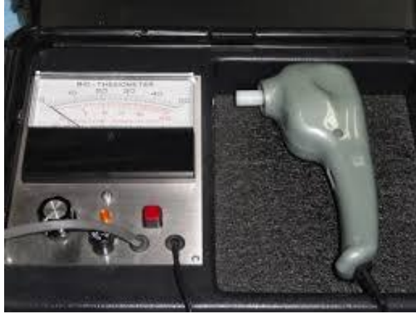
Εικόνα 3. Βιοθεσιόμετρο – Όργανο για μέτρηση του βαθμού ευαισθησίας στο Αίσθημα Κραδασμών ( http://www.diabeteslimassol.com/?page_id=154 )
