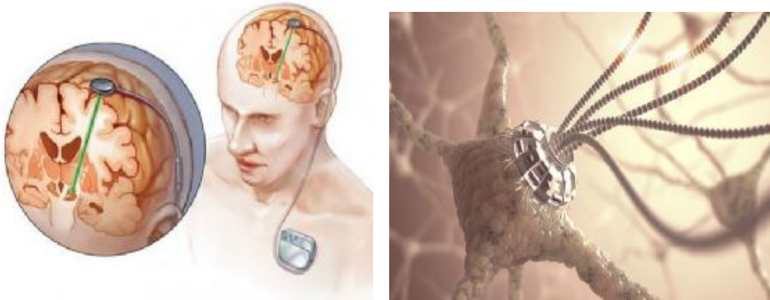
Εικόνα 18: Εν τω βάθει διέγερση του εγκεφάλου με νανο-ηλεκτρόδια.
