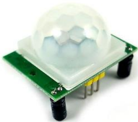
Εικόνα 13 Αισθητήρας παθητικών υπεράχων PIR
