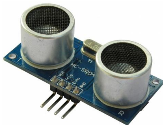
Εικόνα 12 Αισθητήρας υπερήχων HC-SR04
