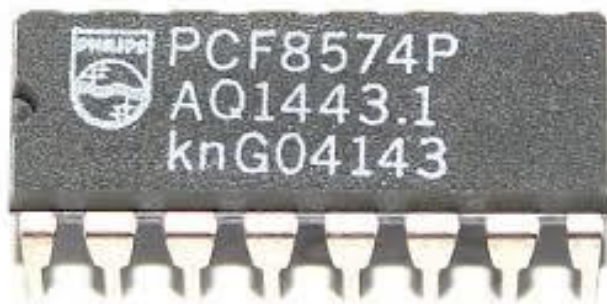
Εικόνα 20 Επιπλέον εισοδοί/έξοδοι με τη χρήση του PCF8574
