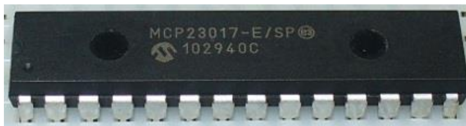
Εικόνα 19 Επιπλέον εισοδοί/έξοδοι με τη χρήση του MCP23017
