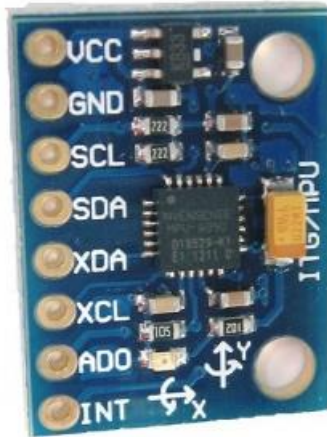
Εικόνα 16 Αισθητήρας κίνησης, γυροσκόπιο και επιταχυνσιόμετρο σε μία πλακέτα MPU 6050
