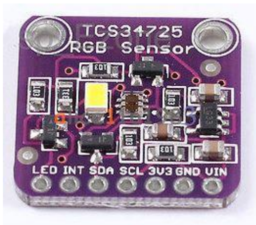
Εικόνα 8 Αισθητήρας χρωμάτων TCS34725
