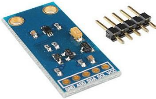
Εικόνα 7 Αισθητήρας έντασης φωτισμού BH1750
