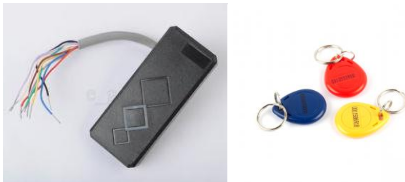
Εικόνα 11 Αισθητήρας wiegand παλμών
