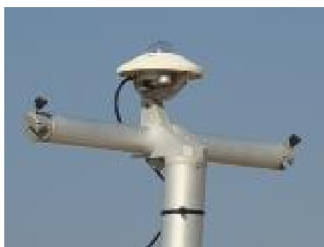
Εικόνα 2.2: Πυρανόμετρο μέτρησης της άμεσης ηλιακής ακτινοβολίας
