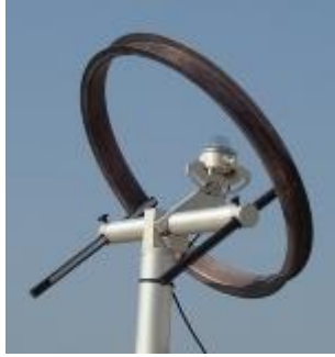
Εικόνα 2.3: Πυρανόμετρο υπολογισμού της διάχυτης ηλιακής ακτινοβολίας
