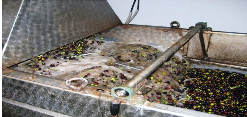
Εικόνα 3.2: Στροβιλισμός του νερού στο θάλαμο εκπλύσεως
