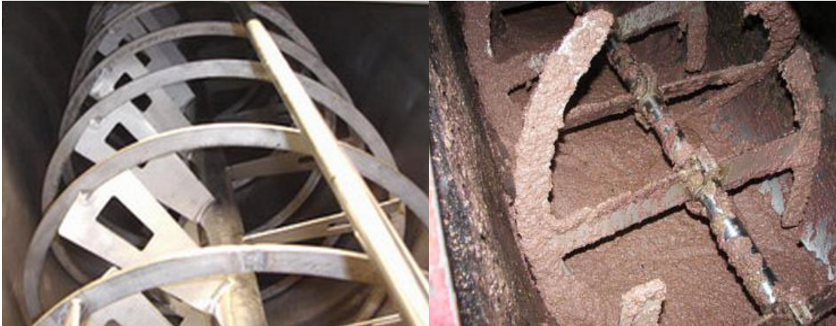
Εικόνα 6.2:(α) ατέρμων κοχλίας με συνεχή σπείρα (ταινία) και πτερύγια -(β) ατέρμων κοχλίας με τομείς
