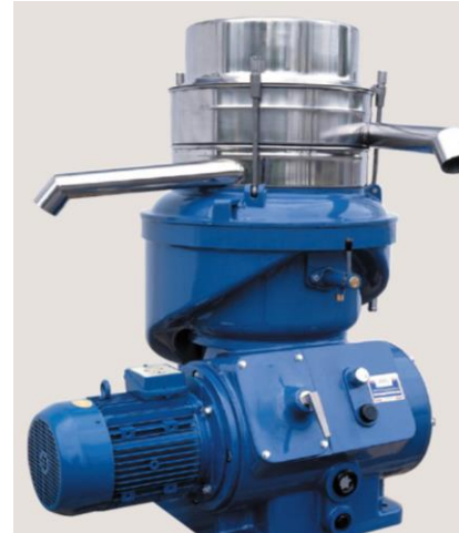
Εικόνα 9.1: Κάθετος φυγοκεντρικός διαχωριστήρας
