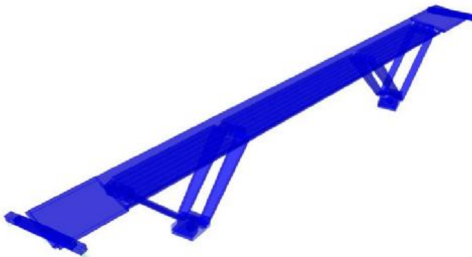
Σχήμα 3- 6 Προσομοίωμα Άνω Διάβασης A296 για την ανάλυση υπό σεισμικά φορτία.
