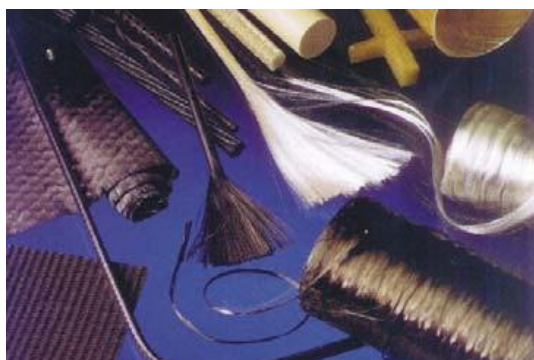
Εικόνα 2- 5: Συνήθεις ίνες άνθρακα και γυαλιού και ινοπλισμένα πολυμερή (FRP)
