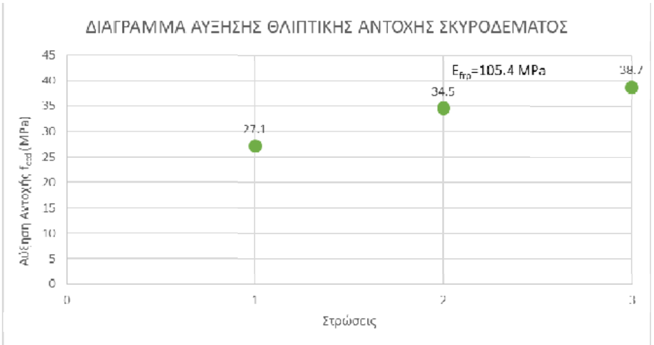
Σχήμα 4- 9: Διάγραμμα αύξησης θλιπτικής αντοχής σκυροδέματος
