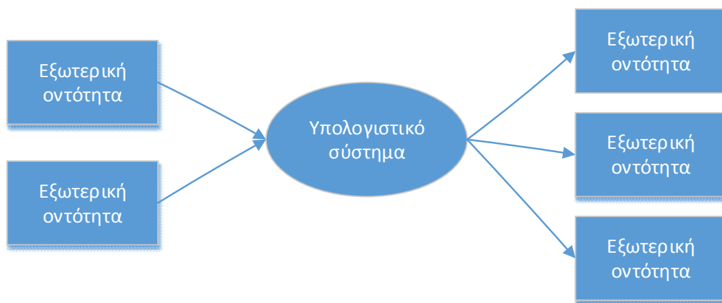
Σχήμα 3.3.2 Γενικό παράδειγμα ενός ΔΡΔ επιπέδου 0
