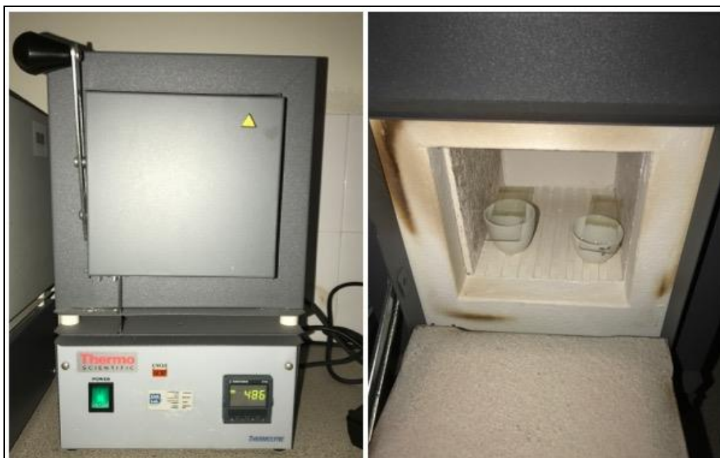
ΣΧΗΜΑ 24: Φούρνος Thermo SCIENTIFIC με τις πλάκες (φιλμ) στο εσωτερικό του για απομάκρυνση των οργανικών.
