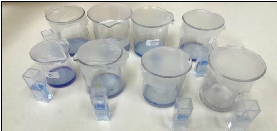
ΣΧΗΜΑ 43: Δείγματα χρωστικής Basic Blue 41 από το πείραμα της φωτοκατάλυσης, σε κυψελίδες για φασματοφωτομετρεία.
