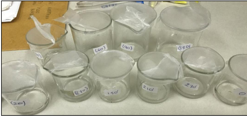
ΣΧΗΜΑ 45: Δείγματα από την φωτοκατάλυση του αντιβιοτικού, προετοιμάζονται για φασματοφωτομετρία.
