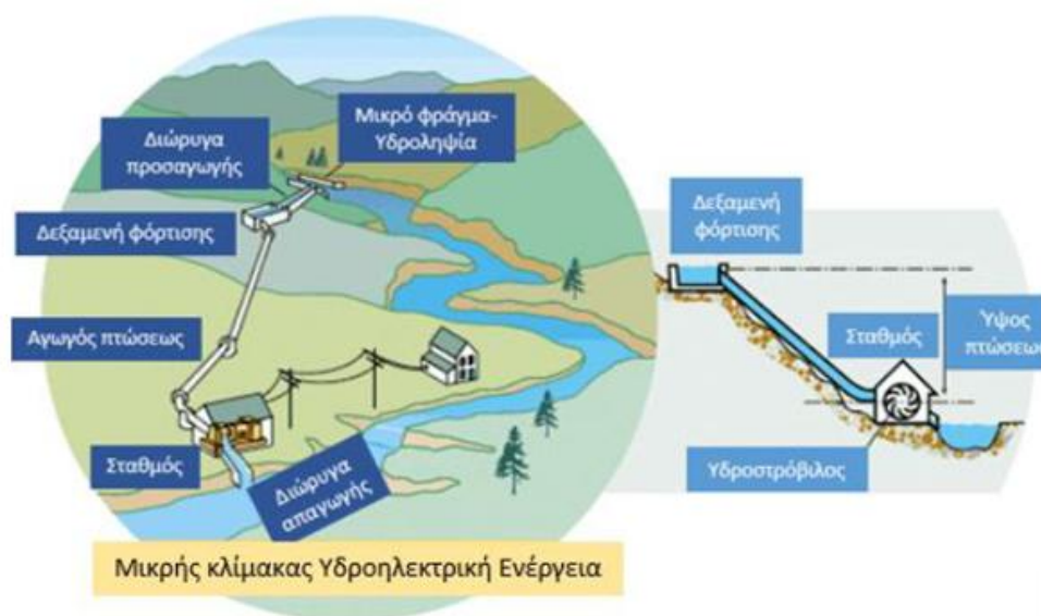
Σχήμα 3.2: Τυπική διάταξη ενός ΜΥΗΕ (Πηγή: Κοντίνη, 2016)
