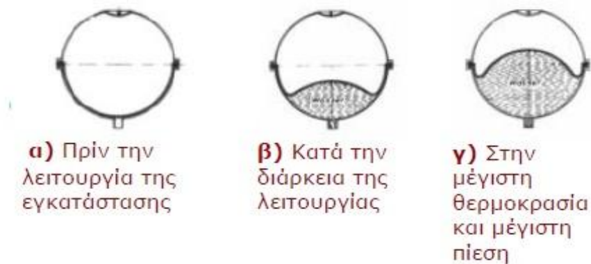
Σχήμα 6.6: Απεικόνιση της λειτουργίας του δοχείου διαστολής
