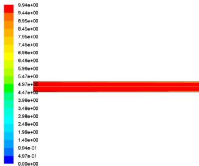
Σχήμα 4.4.10: Κατανομή ταχύτητας σε αγωγό χωρίς πλάκα – Μονοφασική ροή
