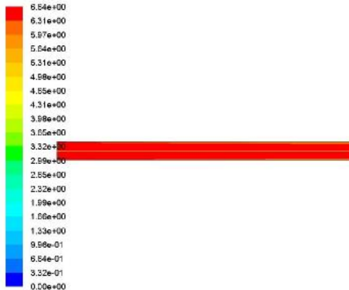
Σχήμα 4.4.7: Κατανομή ταχύτητας σε αγωγό χωρίς πλάκα – Μονοφασική ροή
