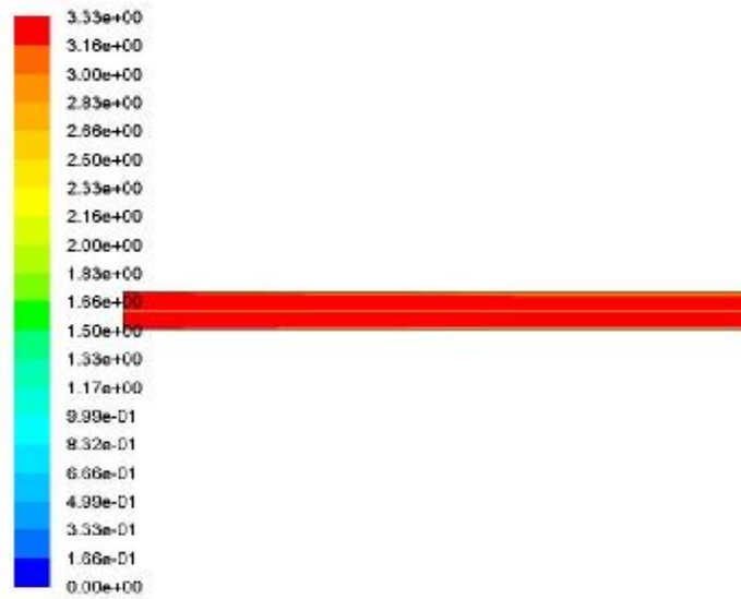
Σχήμα 4.4.3: Κατανομή ταχύτητας σε αγωγό χωρίς πλάκα – Μονοφασική ροή
