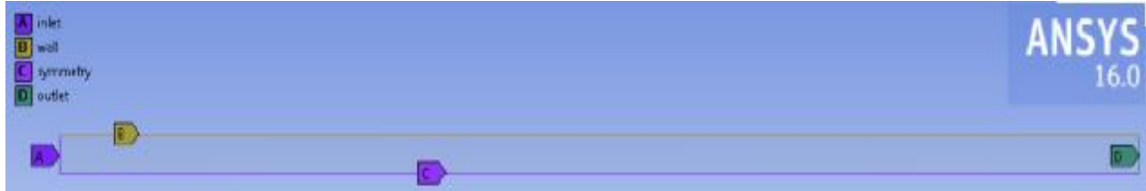
Εικόνα 3.4.3: Οριακές συνθήκες γεωμετρίας
