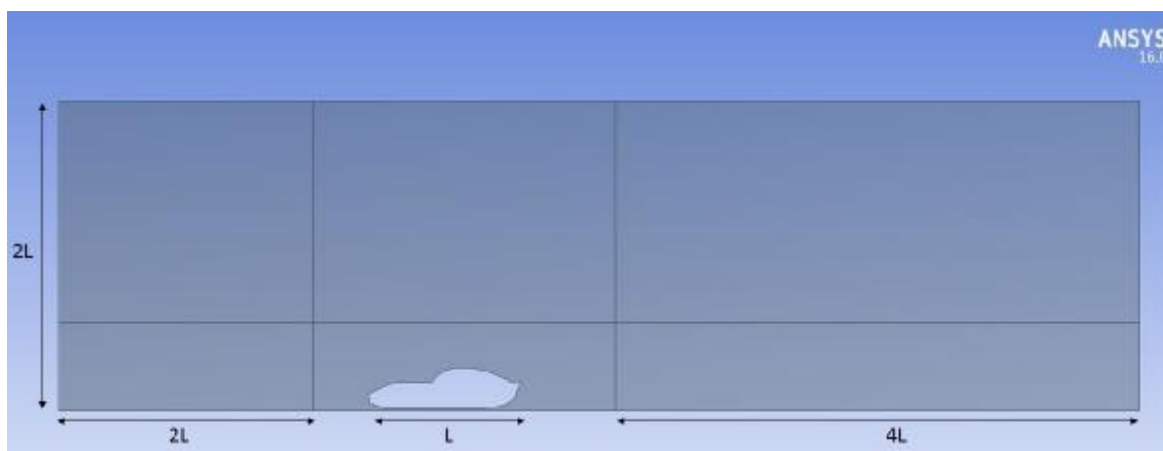
Σχήμα 4.4: Γεωμετρία υπολογιστικής προσομοίωσης – Βασικές διαστάσεις
