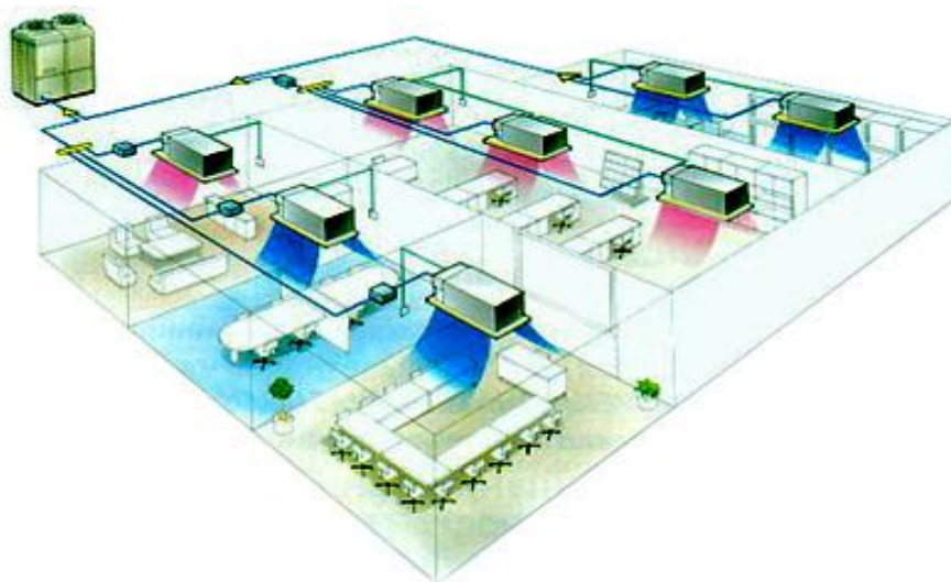
Εικόνα 12: Κεντρικό σύστημα κλιματισμού.
