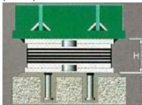
Ελαστομεταλλικά αγκυρούμενα με διπλές εξωτερικές μεταλλικές πλάκες και βλήτρα αγκύρωσης (Τύπου 4).
