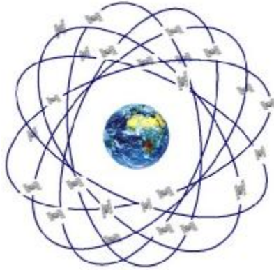
Εικόνα 1.7.: Δορυφόροι GPS τοποθετημένοι σε τροχιακά γύρω από τη Γη
