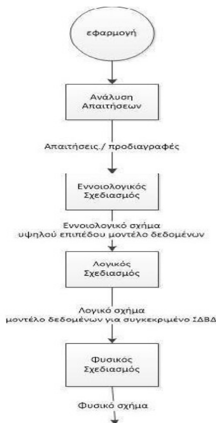
Εικόνα 3.5.1 Εννοιολογικό, Λογικό και Φυσικό σχήμα
