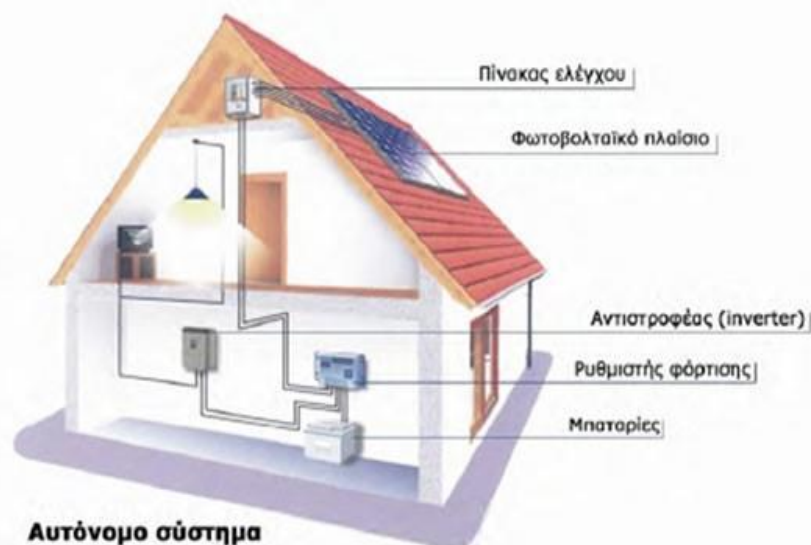
Εικόνα 33 Αυτόνομο φωτοβολταϊκό σύστημα
