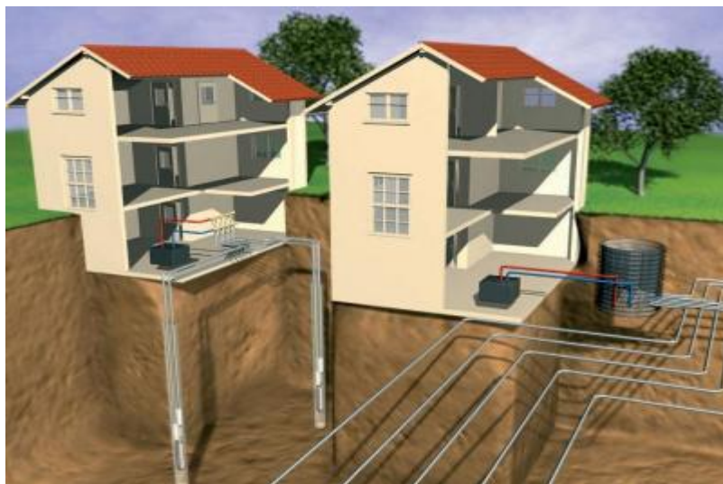
Εικόνα 15: Σύστημα Γεωθερμίας σε κατοικίες.
