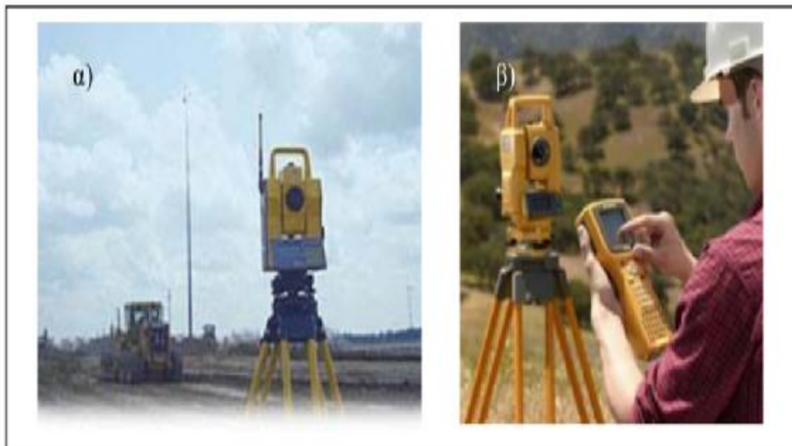
Σχήμα 2.1 α) Ρομποτικός θεοδόλιχος Trimble 5600 και β) ρομποτικός θεοδόλιχος της Topcon.
