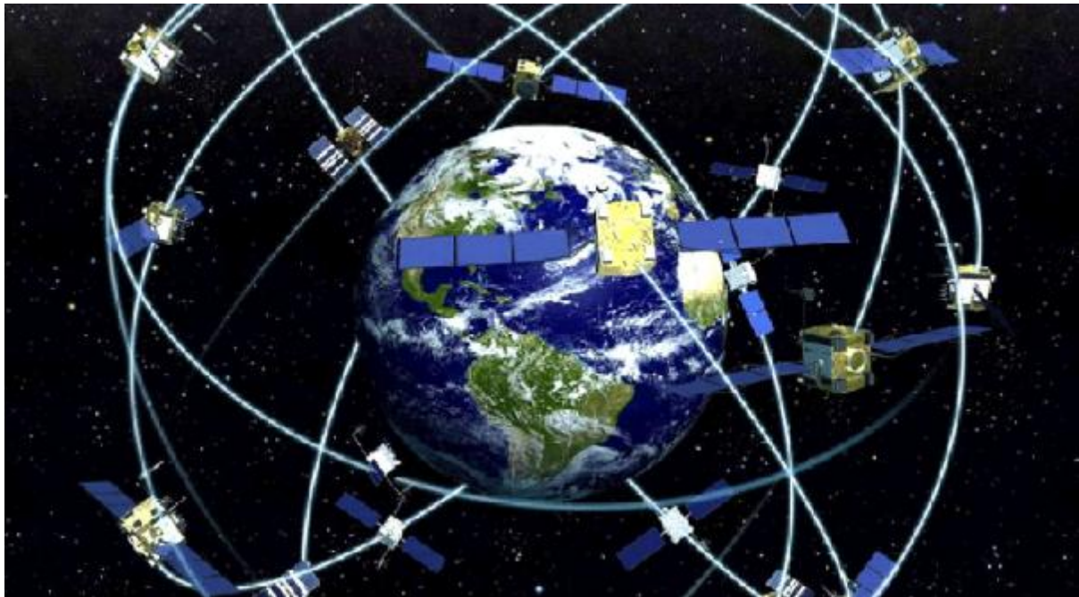
Σχήμα 1.2 Το δίκτυο των 24 δορυφόρων που είναι ομοιόμορφα κατανεμημένοι σε 6 σχεδόν κυκλικές τροχιές.
