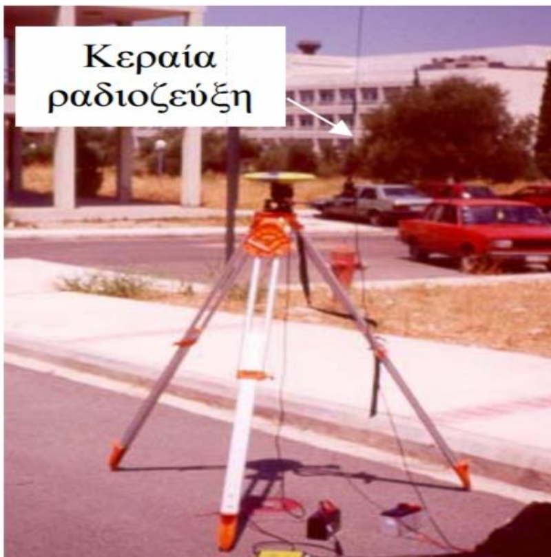
Σχήμα1.12 Σύστημα GPS-RTK το οποίο λειτουργεί με ραδιοζεύξη.
