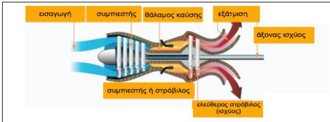
Εικόνα 53 Turboshaft – αξονοστρόβιλος ( https://goo.gl/images/aBjNKQ )
