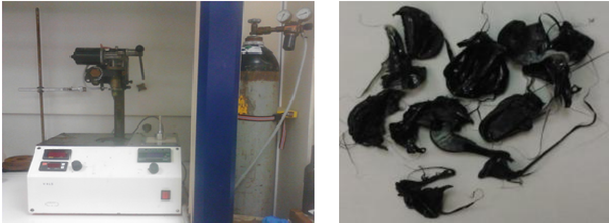
Εικόνα 14: Εργαστηριακός ταχυναμεικτήρας, εφοδιασμένος με κυλινδρικό ρότορα, συνδεδεμένος με φιάλη προς δημιουργία αδρανούς ατμόσφαιρας και δείγμα όπως βγαίνει από αυτόν
