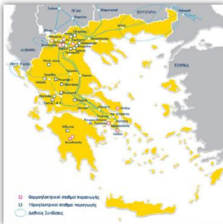
Εικόνα 11: Χάρτης διασυνδεδεμένου συστήματος μεταφοράς ηλεκτρικής Ενέργειας.
