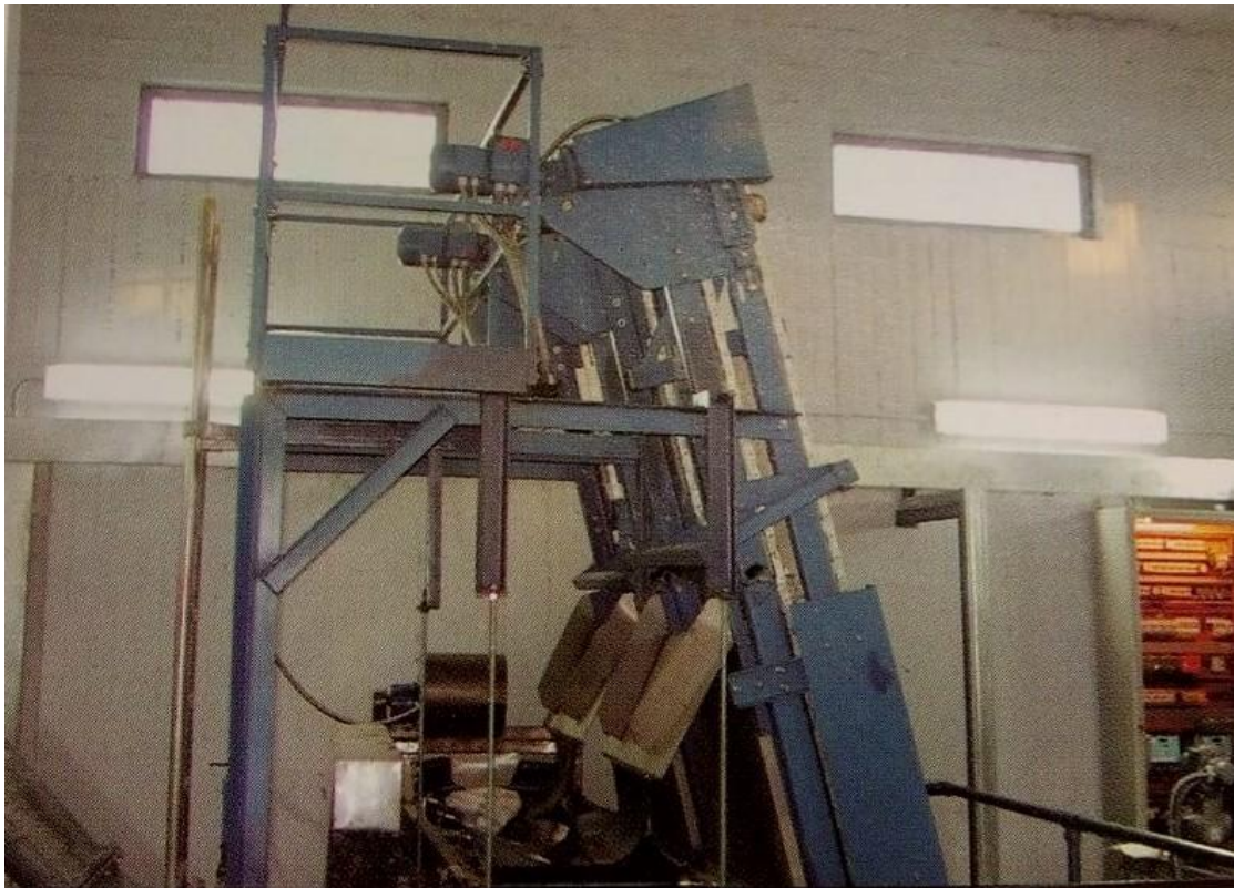
Εικόνα 14. Μηχανικά αυτοκαθοριζόμενες εσχάρες.
