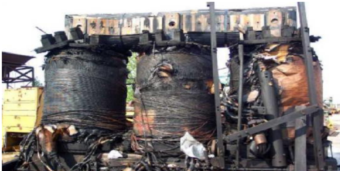
Σχ.1.7 Μετασχηματιστής λαδιού έπειτα από έκρηξη
