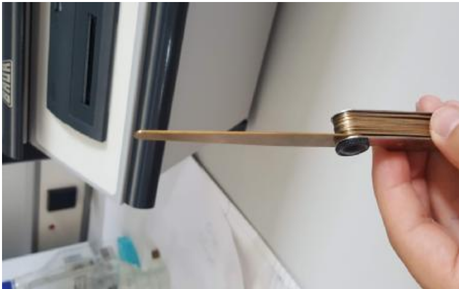
Εικόνα 3.6 Filler 2,5mm :Το χρησιμοποιήσαμε για το πρότυπο IEC 60156
