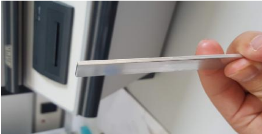
Εικόνα 3.7 Filler 1,00mm :Το χρησιμοποιήσαμε για το πρότυπο ASTM D1816:2004
