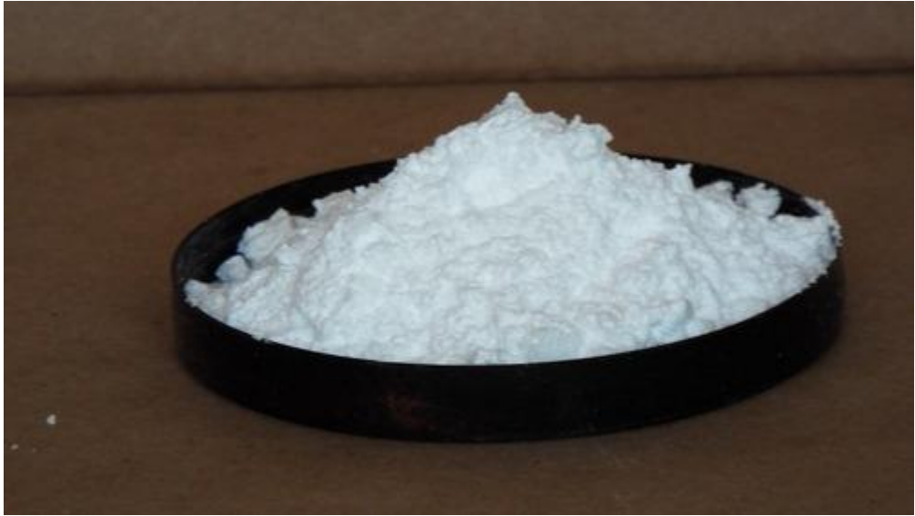
Εικόνα (3) PTFE ή τεφλόν σε μορφή σκονης
