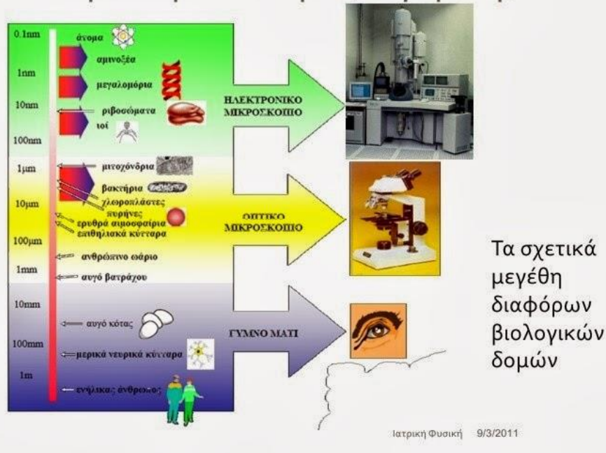
Εικόνα (30) Σχηματική απεικόνιση της διακριτικής ικανότητας κάθε συσκευής παρατήρησης
