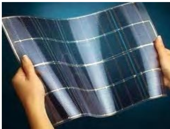
Εικόνα 5.4: Εύκαμπτη φωτοβολταϊκή κυψέλη άμορφου πυριτίου. Πηγή: Διαδίκτυο, 2019.
