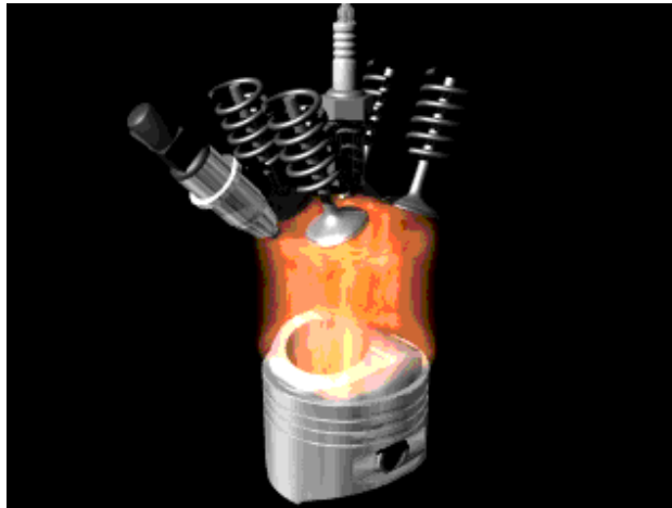
Εικόνα 6.2.4 (β) Ψεκασμός κατευθείαν στον κύλινδρο
