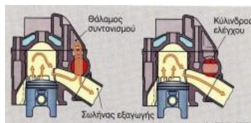
Σχήμα 1: Έλεγχος εξαγωγής με θάλαμο συντονισμού
