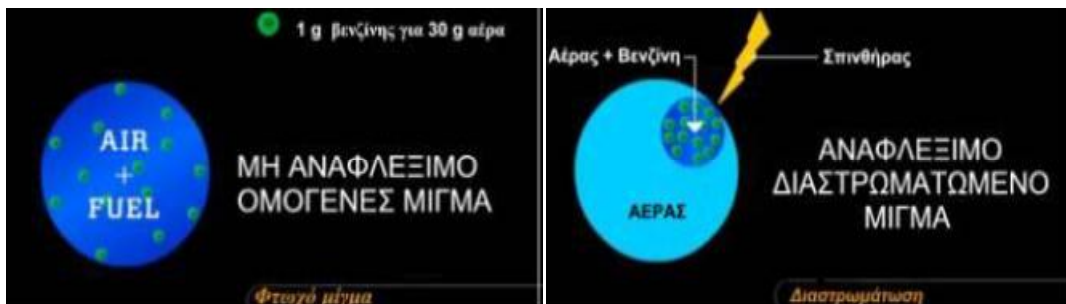
Εικόνα 6.2.4(α) Καύση με άμεσο ψεκασμό
