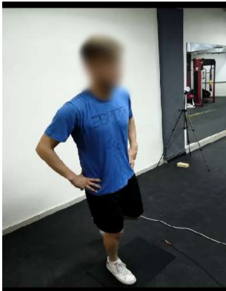
Εικόνα 13: Δοκιμαζόμενος πριν την εκκίνηση των τριπλών κατακόρυφων αλμάτων πάνω στον ηλεκτρονικό τάπητα
