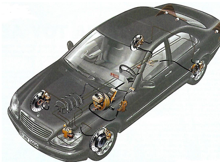
Σχήμα 6.1 Το συνολικό σύστημα φρένων της S-Class συμπεριλαμβανομένου του BAS [2].
