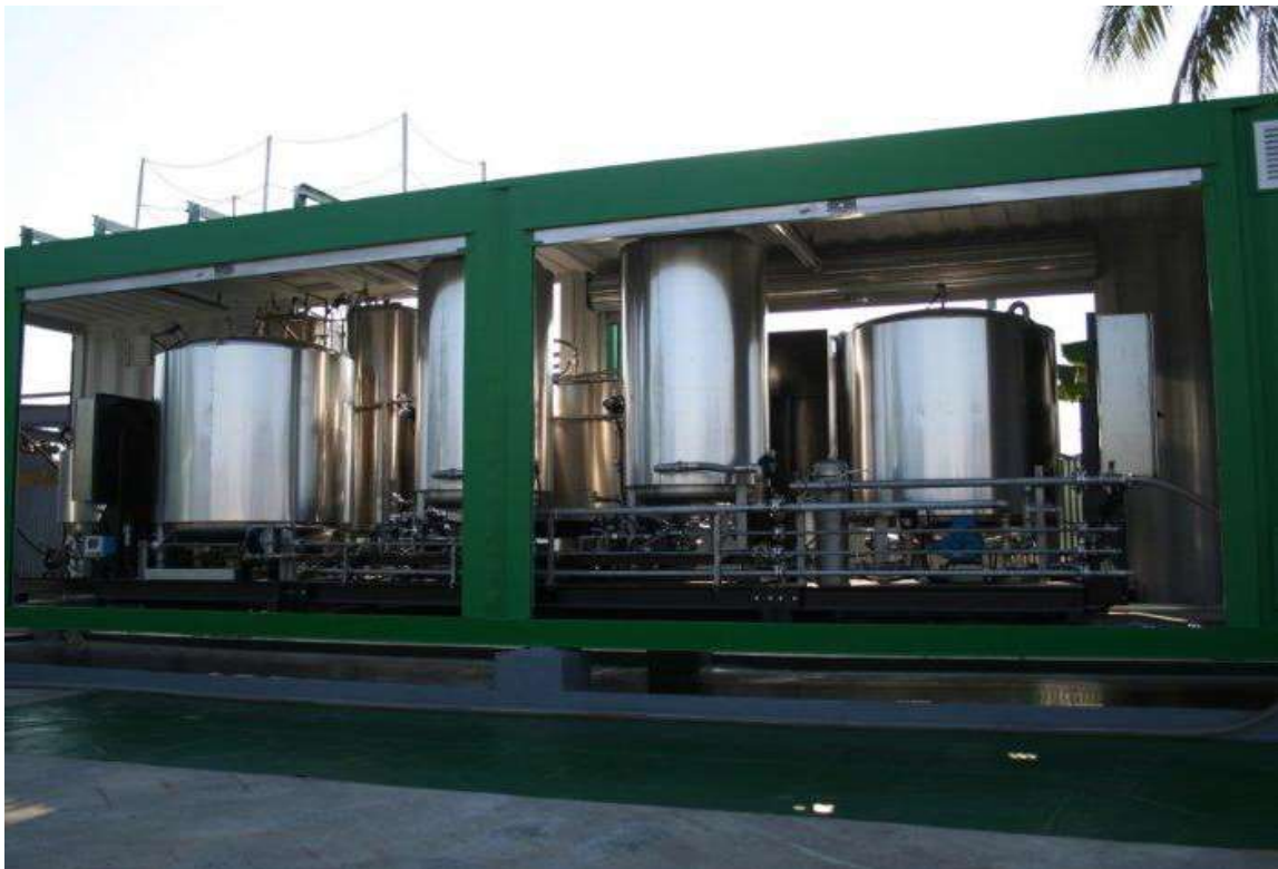
Εικόνα 28: Φορητή μονάδα παραγωγής βιοντίζελ σε εμπορευματοκιβώτια [158]
