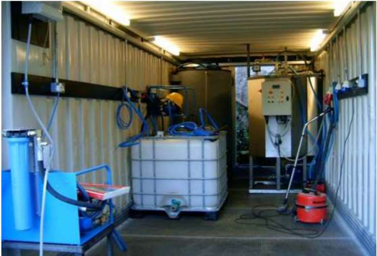
Εικόνα 32: Συσκευασία αντιδραστήρα παρτίδας βιοντίζελ σε κοντέινερ, κοντά στο στάδιο της θέσης σε λειτουργία [156]
