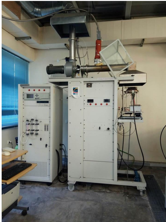
Εικόνα 3.3 Θερμιδόμετρο κώνου και τα μέρη του.
