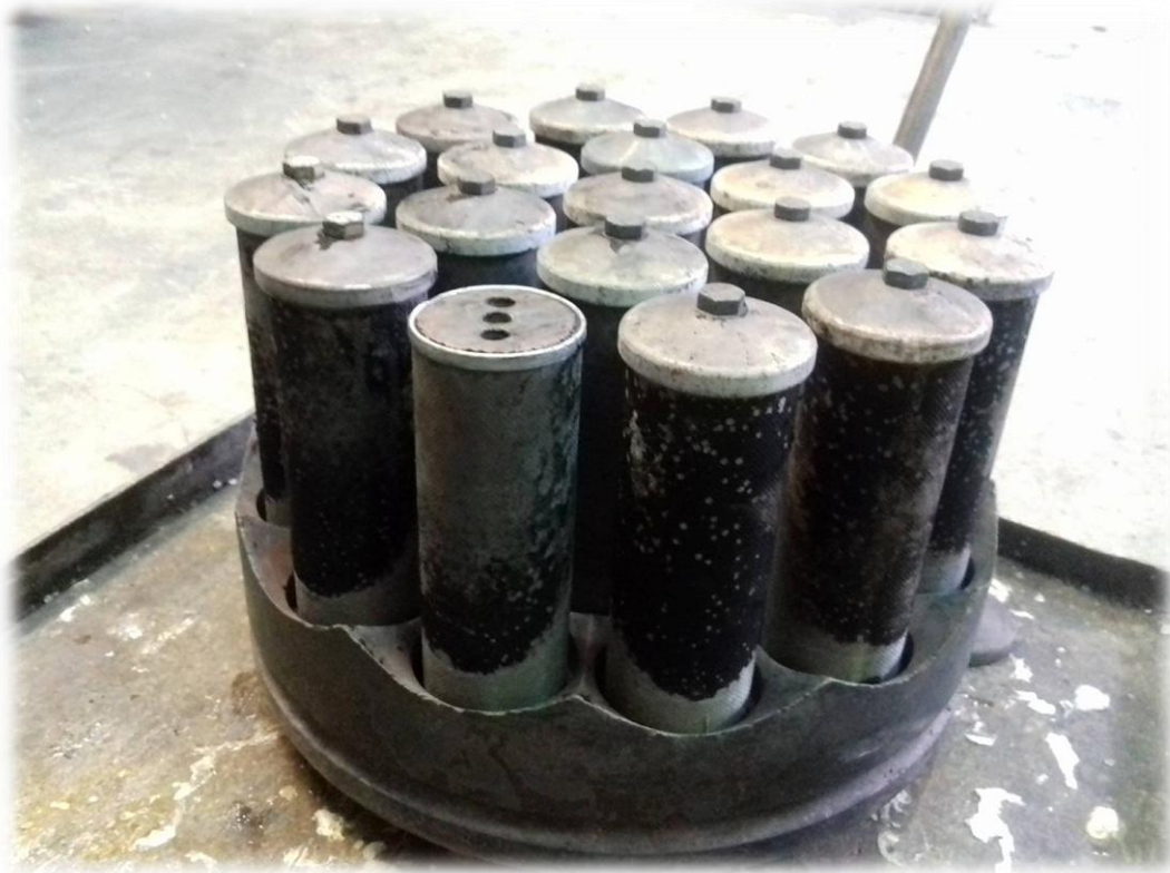
Εικόνα 3.14: Χρησιμοποιημένο φίλτρο κυλινδρικού σχήματος.
