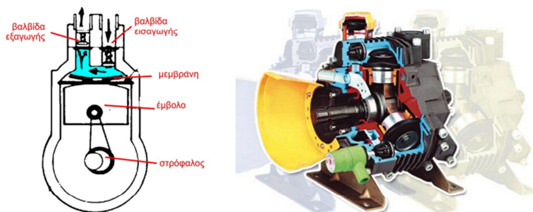
Εικόνα 29 - Σχηματική διάταξη συστήματος αντλίας εμβόλου – μεμβράνης (αριστερά). Τομή αντλίας μεμβράνης – εμβόλου με τρεις κυλίνδρους σε σχήμα αστέρα (δεξιά).
