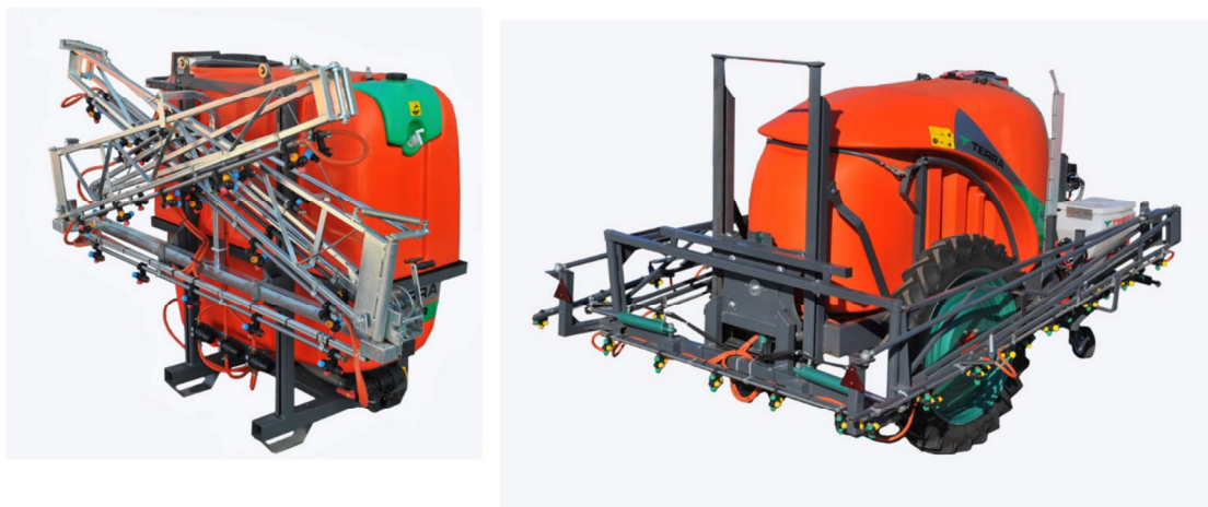
Εικόνα 36 - Ψεκαστικά μεγάλων (αροτριάων) καλλιεργειών. Φερόμενο (αριστερά), ελκόμενο (δεξιά).
