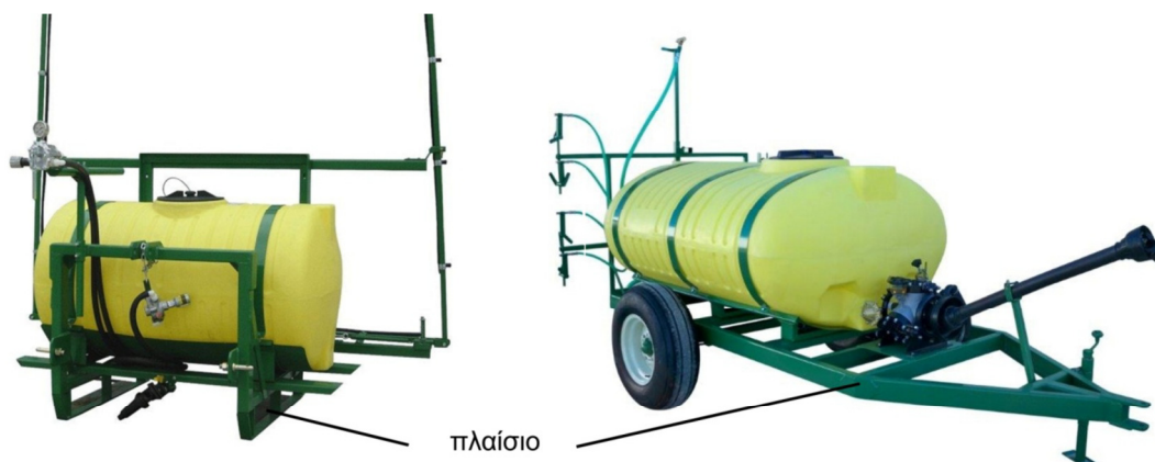
Εικόνα 18- Ψεκαστικό αναρτώμενο στο υδραυλικό σύστημα ανάρτησης του γ.ε. (αριστερά), ψεκαστικό ελκόμενο (δεξιά).
