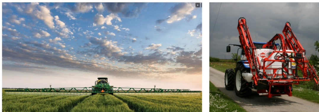
Εικόνα 34 - Ιστός σε έκπτυξη για διενέργεια ψεκασμού στο χωράφι (αριστερά), ιστός σε αναδίπλωση για μεταφορά του ψεκαστικού σε δρόμους (δεξιά).
