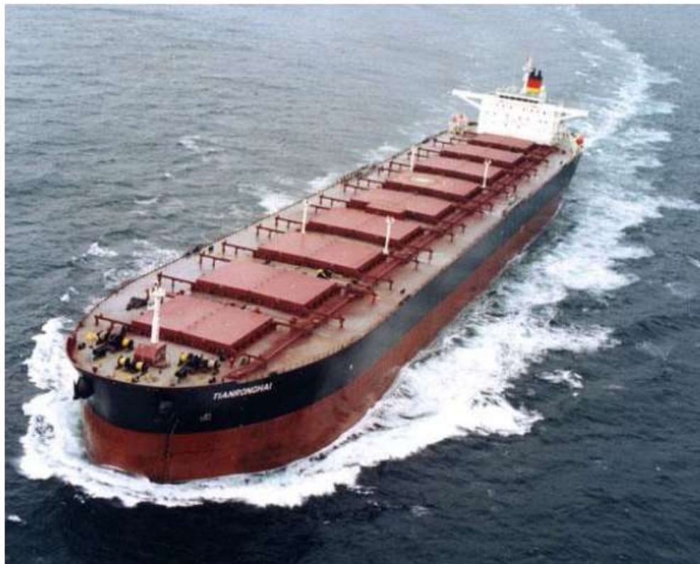
Εικόνα 6. Πλοίο τύπου Capesize bulk carrier
