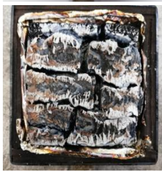
Εικόνα 4.13: Χαρακτηριστικές φωτογραφίες του υλικού T02014 πριν και μετά την καύση
