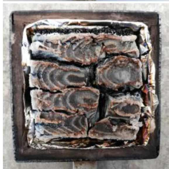
Εικόνα 4.23: Χαρακτηριστικές φωτογραφίες του υλικού T02022 πριν και μετά την καύση
