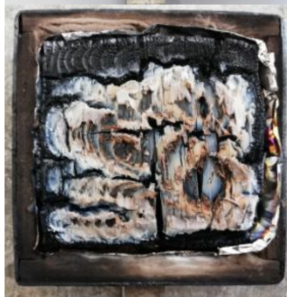
Εικόνα 4.11: Χαρακτηριστικές φωτογραφίες του υλικού T02009 πριν και μετά την καύση
