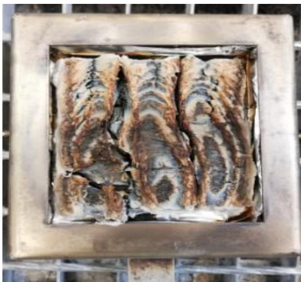
Εικόνα 4.1: Χαρακτηριστικές φωτογραφίες του υλικού T02000 πριν και μετά την καύση
