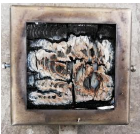
Εικόνα 4.11: Χαρακτηριστικές φωτογραφίες του υλικού T02009 πριν και μετά την καύση
