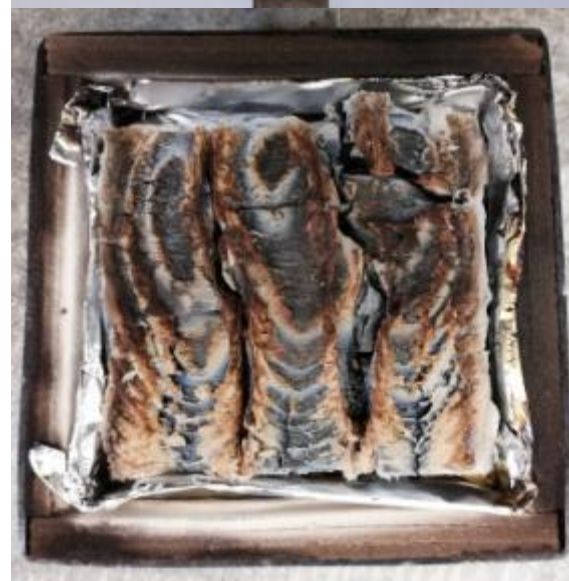
Εικόνα 4.1: Χαρακτηριστικές φωτογραφίες του υλικού T02000 πριν και μετά την καύση
