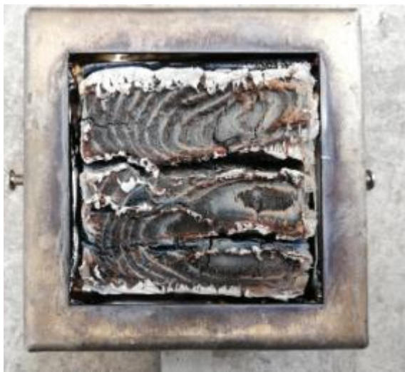
Εικόνα 4.21: Χαρακτηριστικές φωτογραφίες του υλικού T02021 πριν και μετά την καύση
