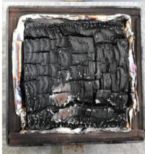
Εικόνα 4.9: Χαρακτηριστικές φωτογραφίες του υλικού T02008 πριν και μετά την καύση
