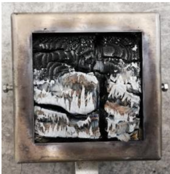
Εικόνα 4.15: Χαρακτηριστικές φωτογραφίες του υλικού T02015 πριν και μετά την καύση
