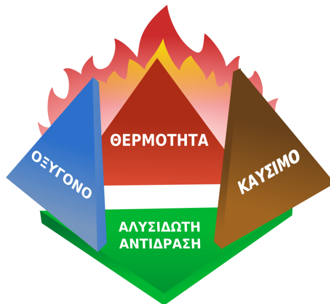
Εικόνα 1.2: Εδώ απεικονίζεται το τετράεδρο της φωτιάς, όπου υπάρχουν τα στοιχεία του τριγώνου της φωτιάς και έχει προστεθεί η χημική αλυσιδωτή αντίδραση.
