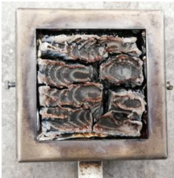
Εικόνα 4.23: Χαρακτηριστικές φωτογραφίες του υλικού T02022 πριν και μετά την καύση
