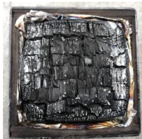
Εικόνα 4.25: Χαρακτηριστικές φωτογραφίες του υλικού T02025 πριν και μετά την καύση
