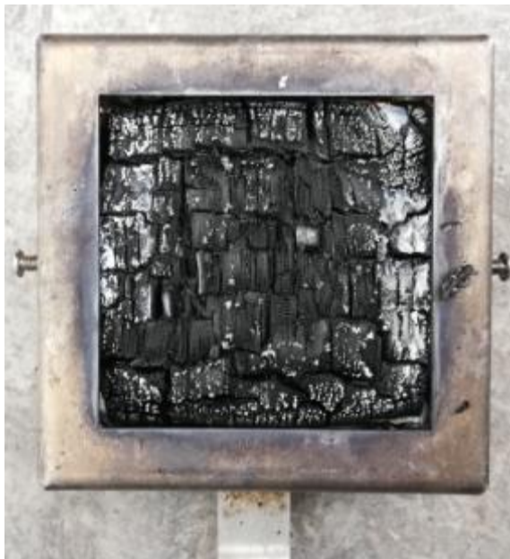
Εικόνα 4.25: Χαρακτηριστικές φωτογραφίες του υλικού T02025 πριν και μετά την καύση
