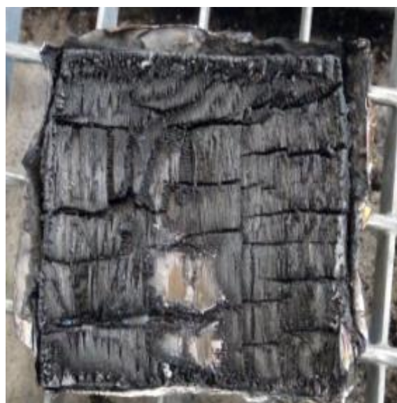
Εικόνα 4.5: Χαρακτηριστικές φωτογραφίες του υλικού T02002 πριν και μετά την καύση
