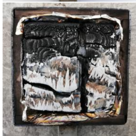
Εικόνα 4.15: Χαρακτηριστικές φωτογραφίες του υλικού T02015 πριν και μετά την καύση
