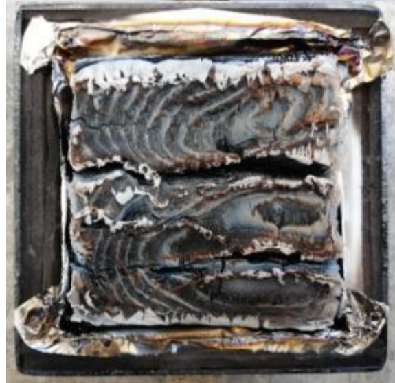
Εικόνα 4.21: Χαρακτηριστικές φωτογραφίες του υλικού T02021 πριν και μετά την καύση
