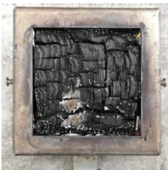
Εικόνα 4.9: Χαρακτηριστικές φωτογραφίες του υλικού T02008 πριν και μετά την καύση
