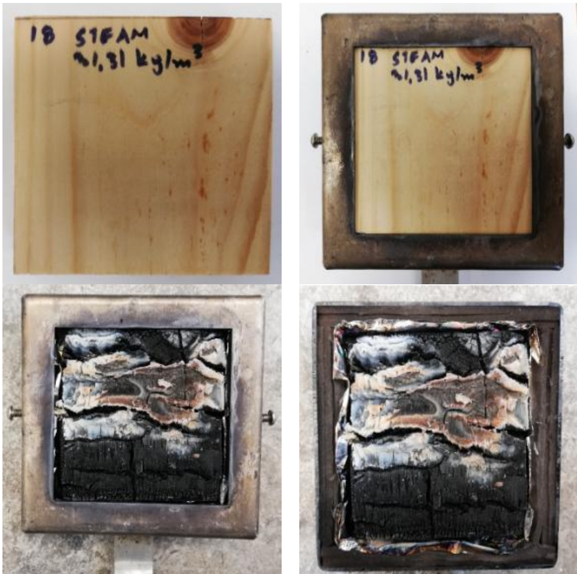
Εικόνα 4.17: Χαρακτηριστικές φωτογραφίες του υλικού T02018 πριν και μετά την καύση
