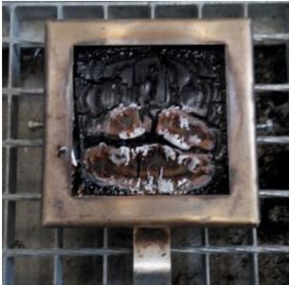
Εικόνα 4.7: Χαρακτηριστικές φωτογραφίες του υλικού T02007 πριν και μετά την καύση
