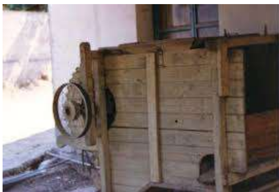
Εικόνα 5 : Μάκινα, μηχανή διαλογής σταφίδας
