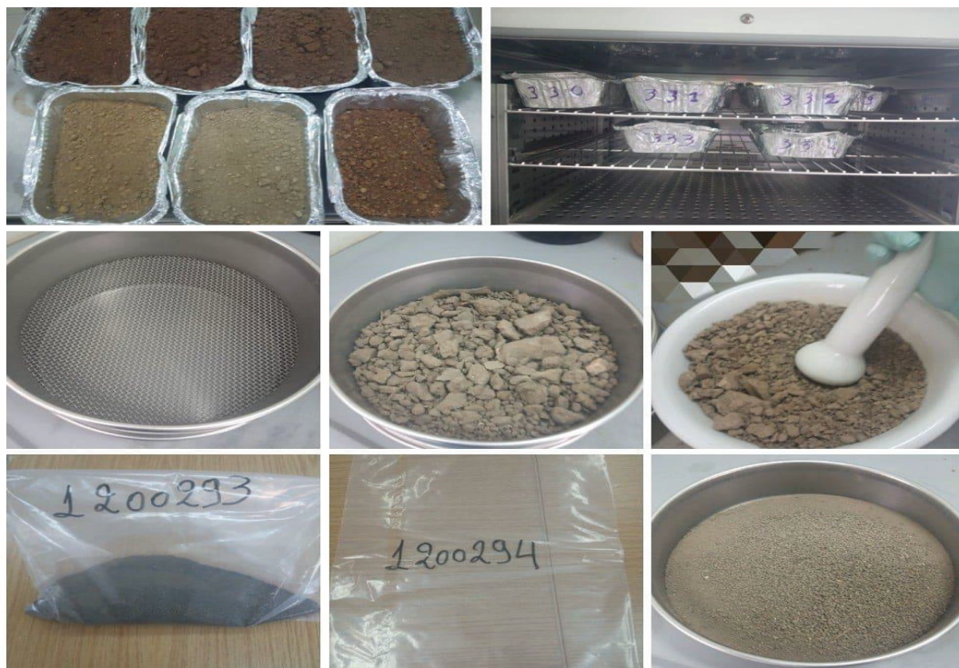
Εικ.4.2 Προετοιμασία εδαφικού δείγματος.
