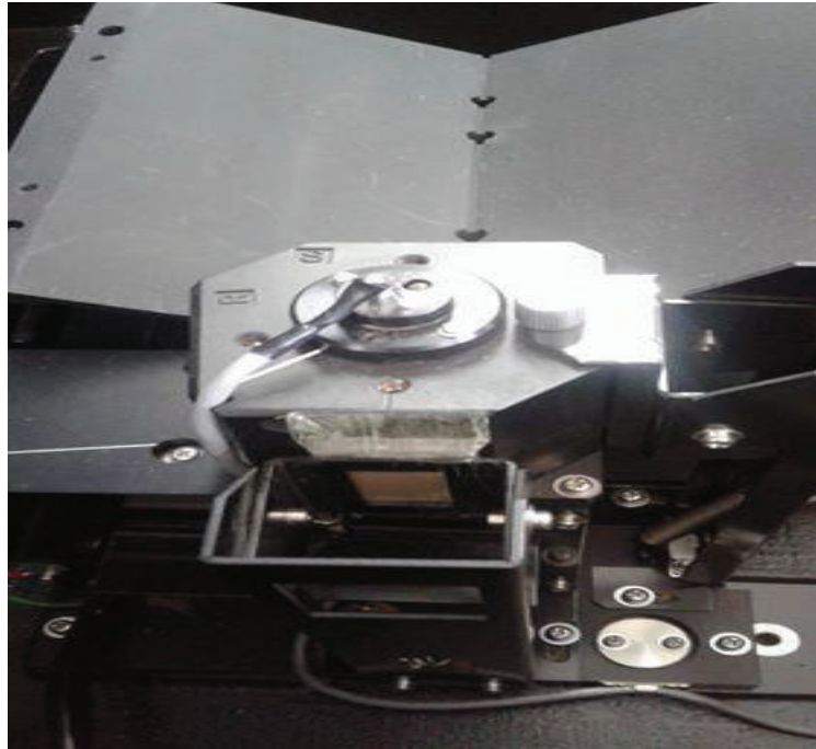
Εικ.4.9 Τοποθέτηση εδαφικού δείγματος στο φασματοφωτόμετρο.
