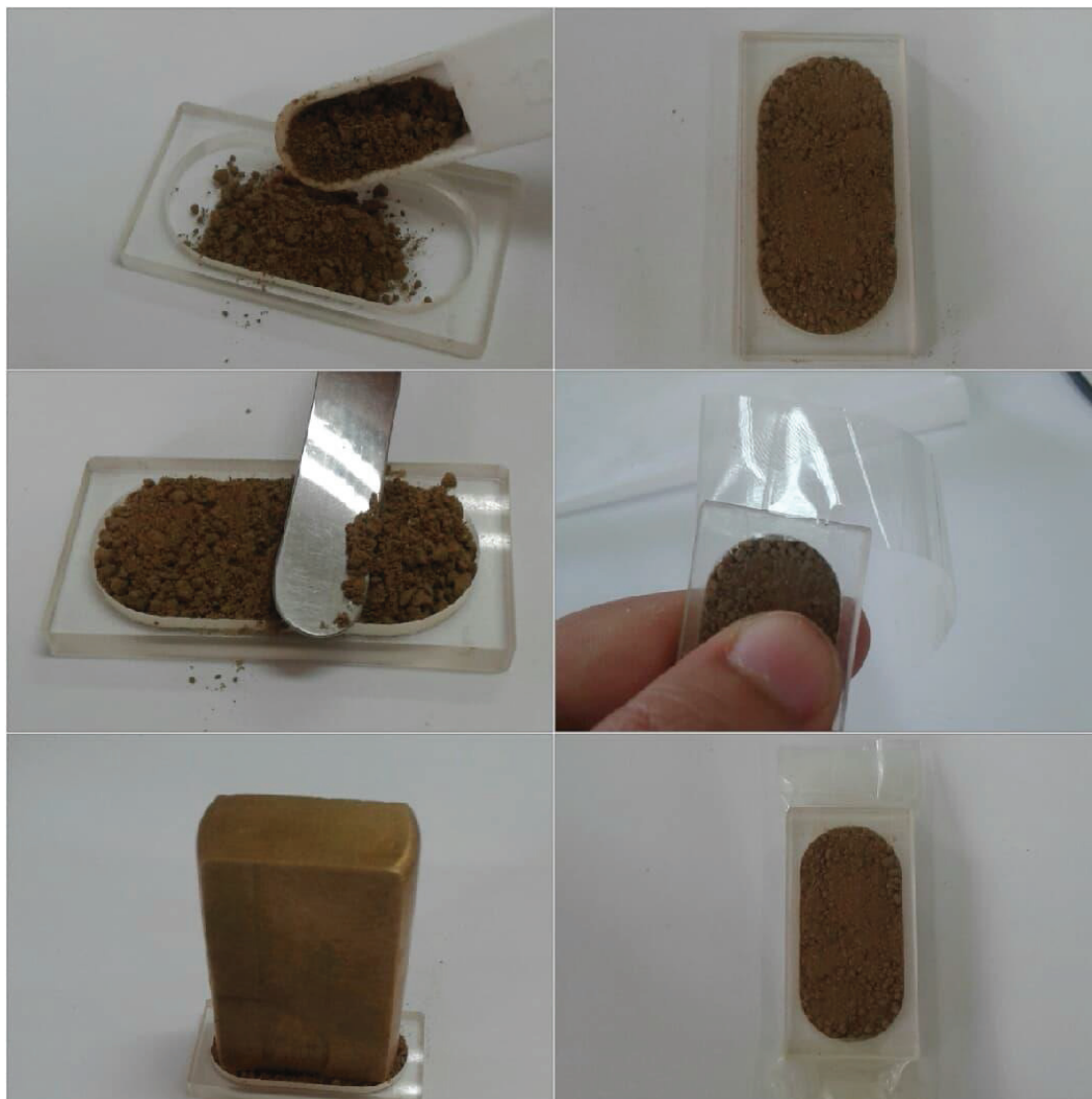
Εικ.4.8 Προετοιμασία εδαφικού δείγματος για μέτρηση στο φασματοφωτόμετρο.
