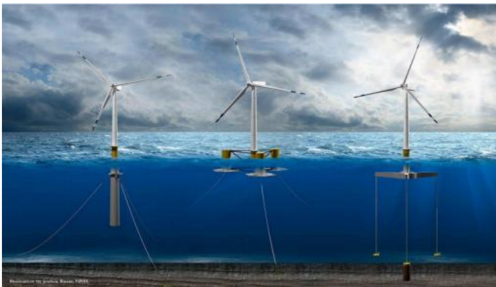
Εικόνα 23 Τρόποι υποθαλάσσιας έδρασης.
